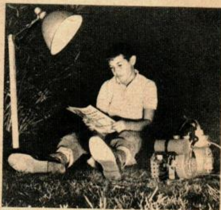
L'éclairage du camp est commodément alimenté par la centrale de 200 watts. Lorsqu'elle est en service, elle doit être installée dans les bois et hors de portée auditive.
