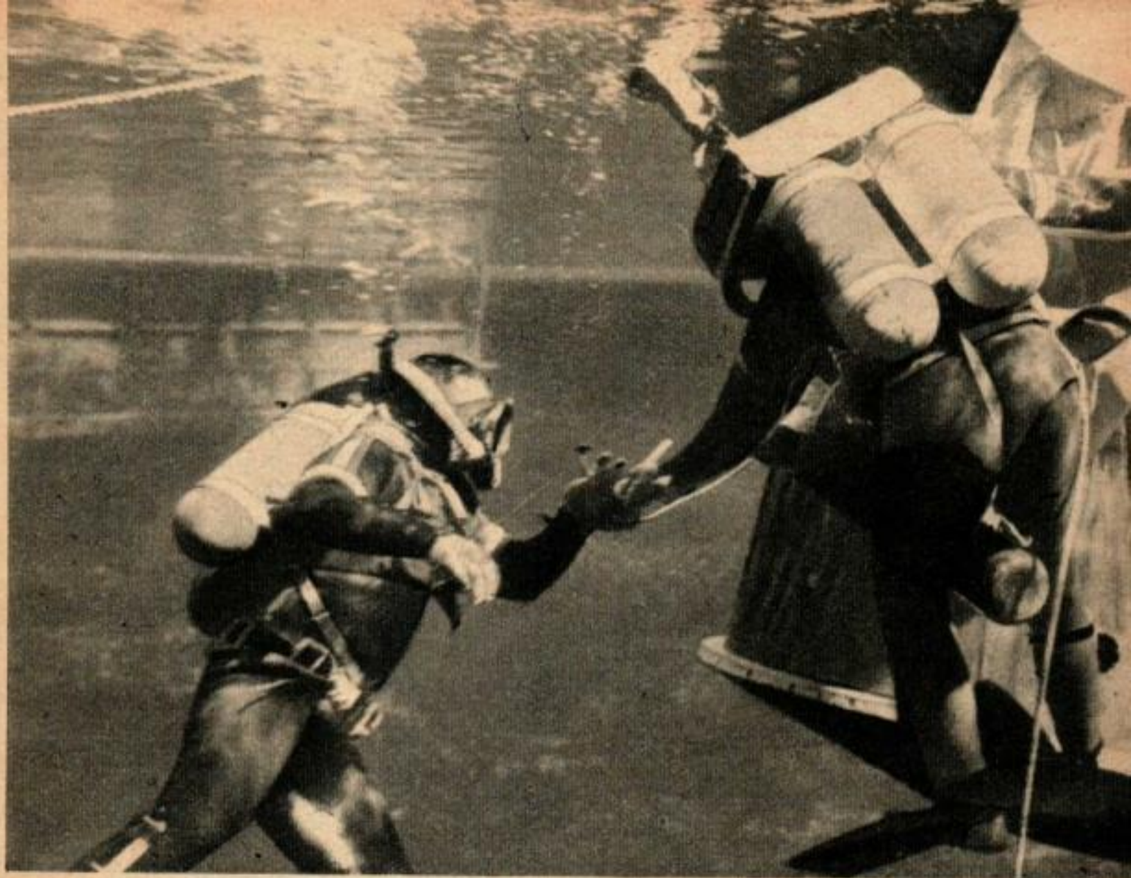
La récupération d'un engin spatial se conduit similairement. Une équipe de deux hommes attache un dispositif de flottaison à la capsule avant de gonfler le dispositif.
