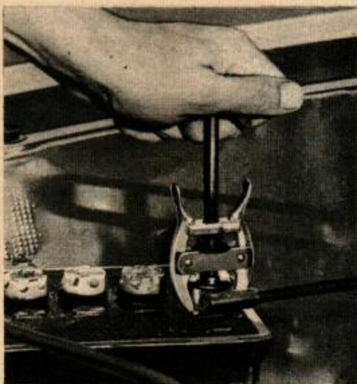
11. CET OUTIL D'ARRACHEMENT DES COSSES de batterie permet d'enlever les cosses des bornes sans endommager ni la cosse ni la borne.
