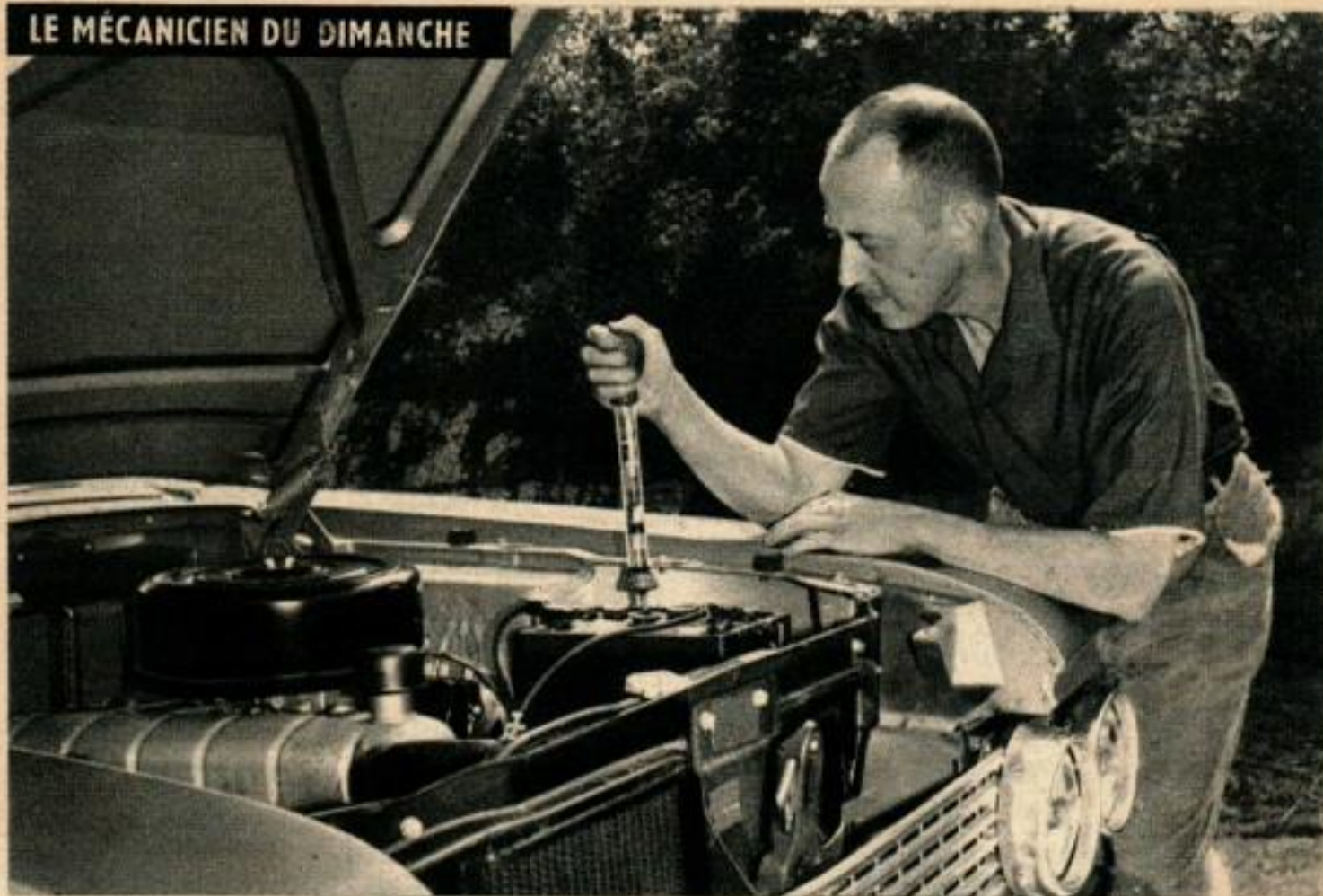
1. L'ESSAI A L'HYDROMETRE montre si la batterie est sous pleine charge. Sous pleine charge, l'indication doit être entre 1,275 et 1,300 ; à demi-charge, elle doit être à environ 1,225 ; à charge très faible, elle est à 1,150. Si l'indication descend à 1,125, la batterie doit être rechargée.
