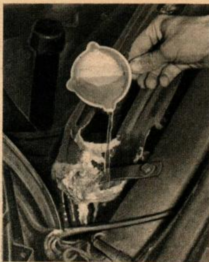
9. LA SOLUTION BICARBONATEE, versée ou appliquée au tampon sur une batterie corrodée et sur son châssis de support, éliminera le dépôt de corrosion. Utilisez approximativement une cuillerée à café de bicarbonate de soude dans un demi-litre d'eau. Après nettoyage, enduisez les pièces de vaseline.
