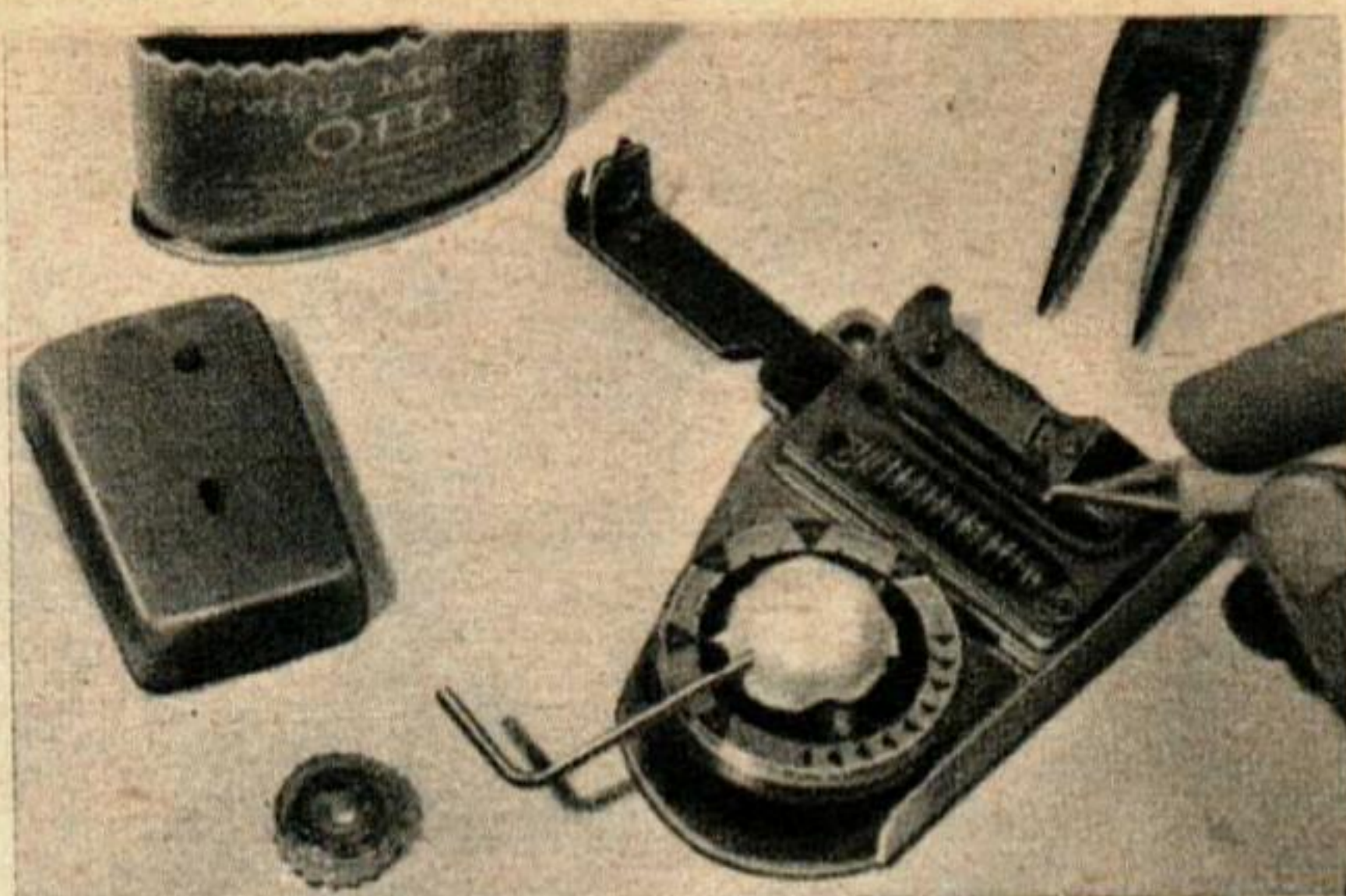
Le levier de déclenchement de la minuterie d'appareil à photo doit être redressé afin qu'il fonctionne avec beaucoup plus de sensibilité.
