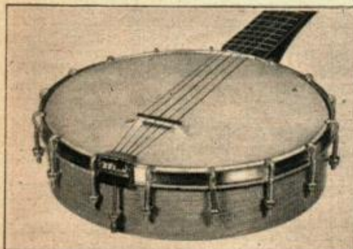
Vue de dessus de la caisse de banjo terminée montrant les cinq cordes, le chevalet, la peau de tambour, le cercle extérieur, l'anneau de tonalité et une partie de la touche complètement assemblés.
