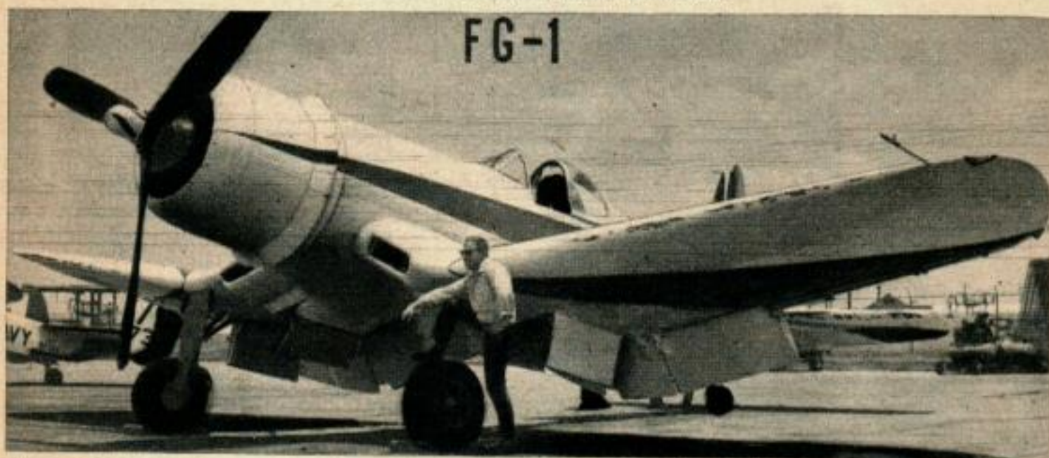
Ce « CORSAIR » GOODYEAR FG-1 (le même que le F4U de la Marine des U.S.A., mais sans les ailes pliantes) est un « runabout » particulier.
