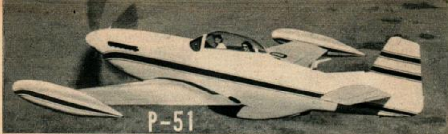
Ce « MUSTANG » P-51 NORTH AMERICAN, un célèbre avion de chasse à grande autonomie, est converti en avion directorial à sièges en tandem.
