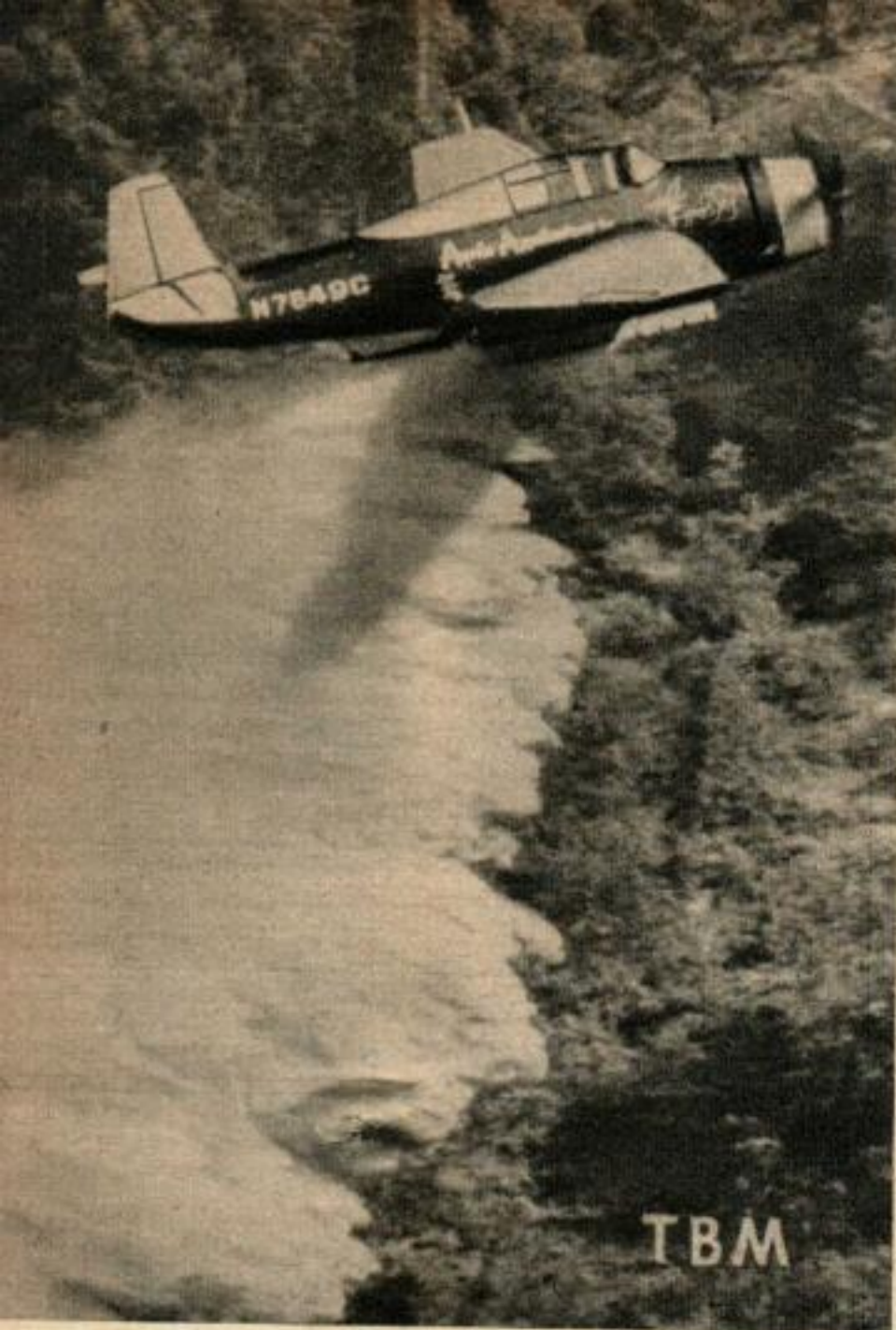
Cet « Avenger » GM, ou TBM (le même que le TBF Grumman), ancien avion torpilleur de la Marine Américaine, combat maintenant les incendies de forêt dans les montagnes de l'Utah.
