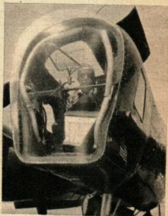
Le nez de ce P-38, dans lequel se trouvait jadis un canon, transporte maintenant un appareil de photographie aérienne.
