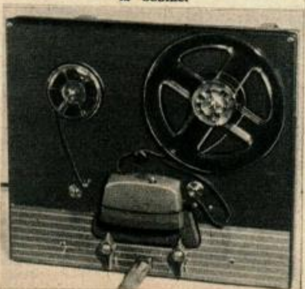
DEUX TYPES DE COMPTEUR. Le modèle du haut compte les tours de la bobine, et il est le plus précis. Celui du bas indique la longueur de ruban déroulée de la bobine.
