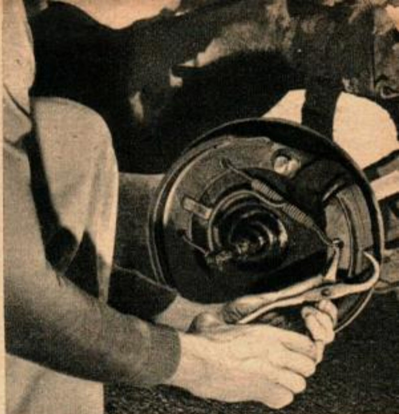
6. Des outils de frein spécialement conçus pour le travail vous feront gagner beaucoup de temps dans le démontage ou le remontage des sabots.
