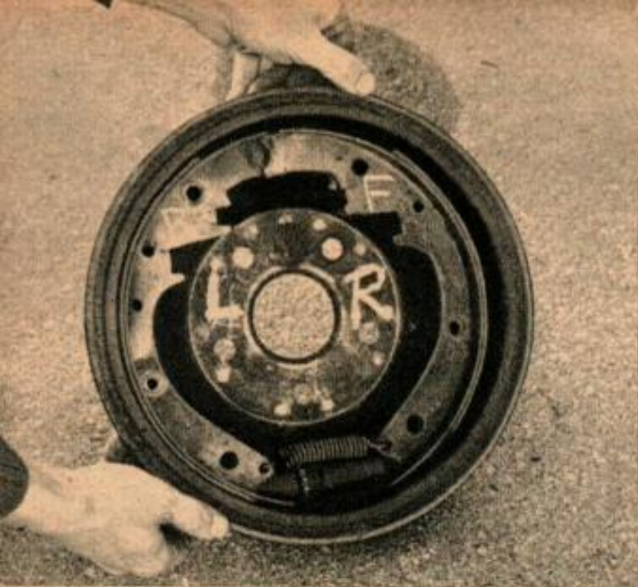
5. Marquez à la craie toutes les pièces de chaque assemblage de frein en les démontant, et remontez-les dans la même séquence.
