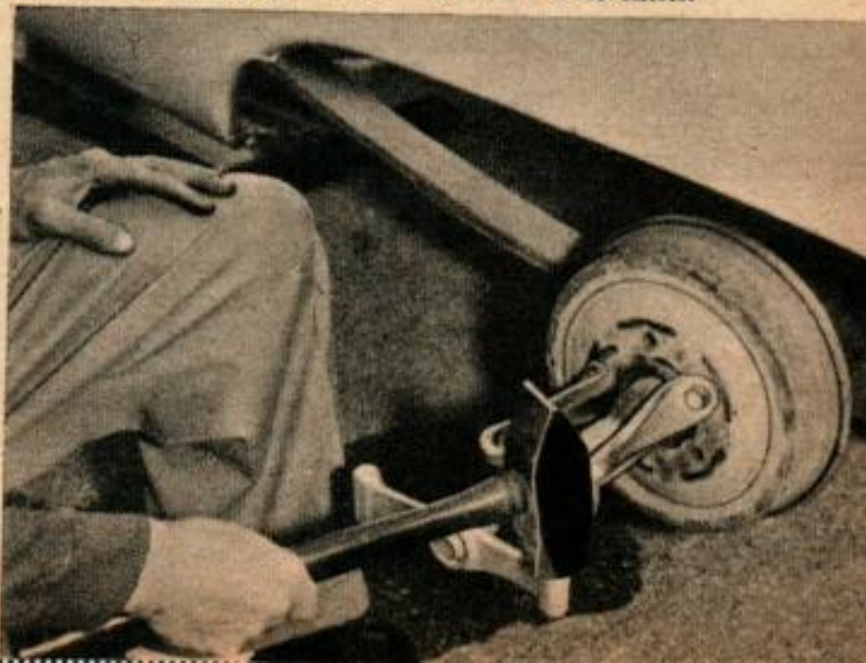
10. Un arrache-moyeu spécial de ce type assure un facile démontage des pièces sans risque d'endommagement de l'essieu arrière ou du différentiel.
