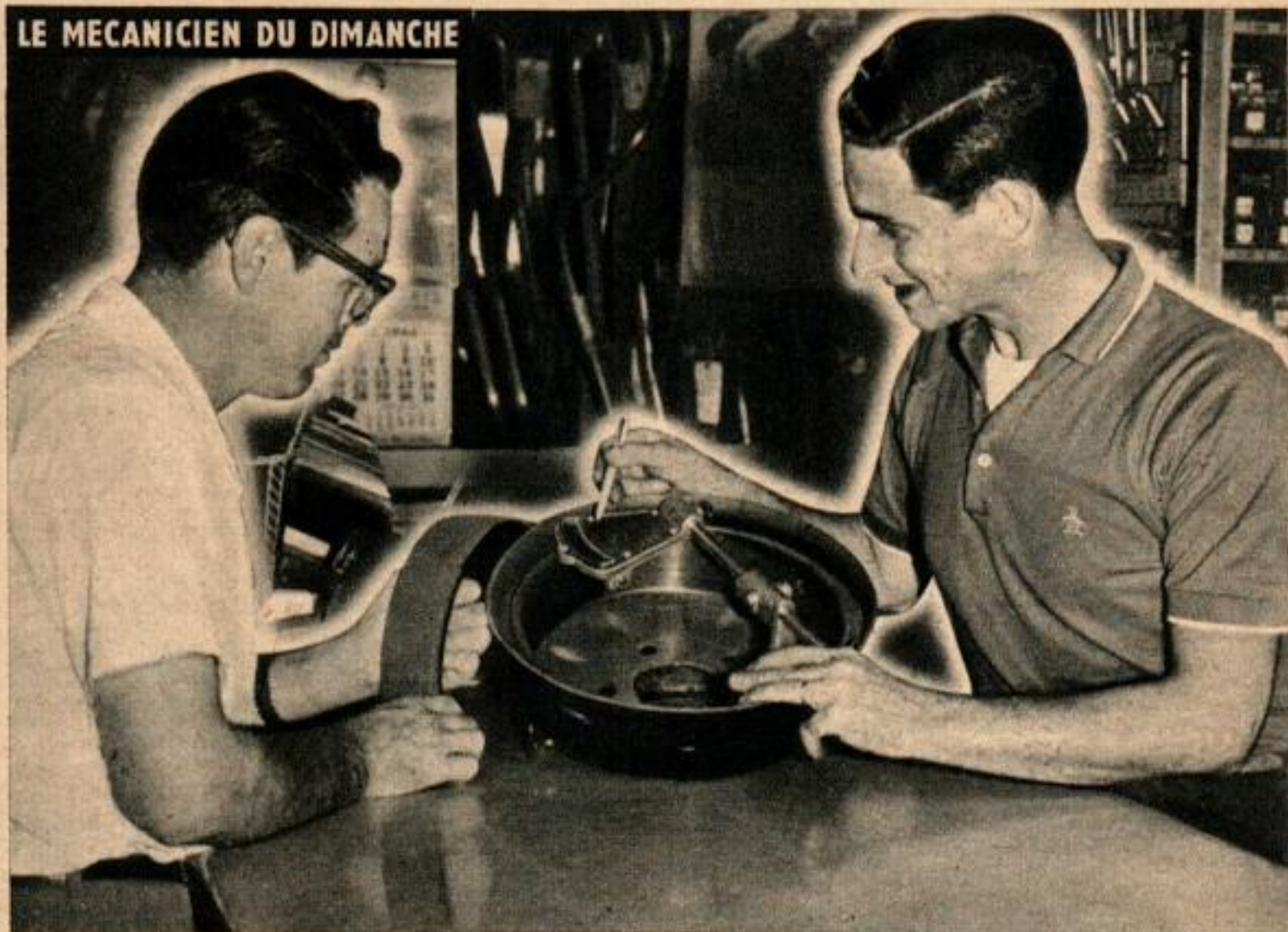
1. Les tambours de frein susceptibles d'être défectueux doivent être vérifiés par votre distributeur de pièces détachées au moyen d'un micromètre spécial pour la mesure des tambours de frein.
