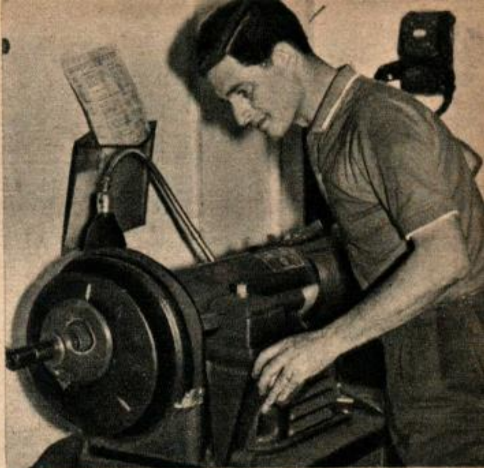
2. La rectification des tambours de frein sur un tour à tambour de freins est à conseiller si vous soupçonnez vos tambours d'être ovalisés.
