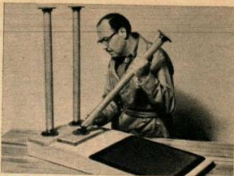
Tous les bords vifs de la plate-forme de la ceinture de massage doivent être arrondis pour éliminer les échardes, puis l'ensemble doit ensuite être poncé.
