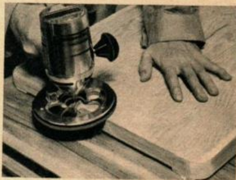
Tous les bords vifs de la plate-forme de la ceinture de massage doivent être arrondis pour éliminer les échardes, puis l'ensemble doit ensuite être poncé.
