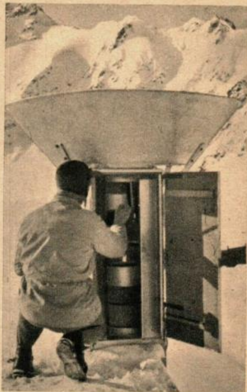
Les hommes du Weissfluhjoch mesurent la pression et la densité de la neige avec des instruments répartis sur près de cinq kilomètres de flanc de montagne. A droite, un spécialiste des avalanches surveille les instruments de mesure des précipitations : ceux-ci enregistrent les chutes de neige électroniquement
