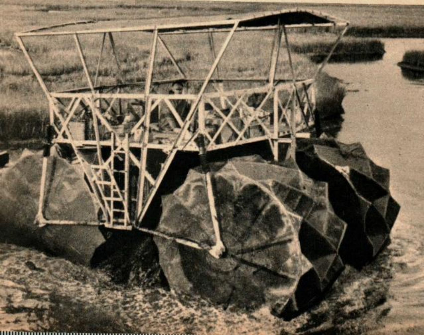
Les prospecteurs font sauter une mine terrestre afin que le matériel lourd puisse passer dans la « brèche » et que l'exploration pétrolière puisse continuer. Dans les « bayous » de la Louisiane (ci-dessous), les gigantesques roues des « tracteurs de marécage » transportent les hommes et le matériel aussi bien sur terre que sur l'eau.
