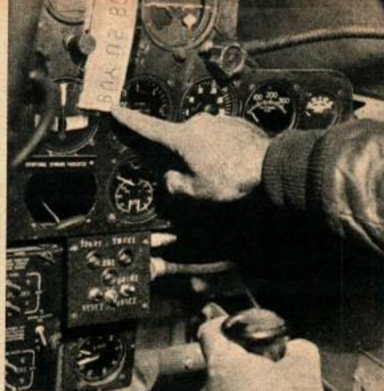
Une « bande » portant le message est montée verticalement dans le cockpit de l'appareil-directeur ; elle correspond au plan de vol de la formation.
