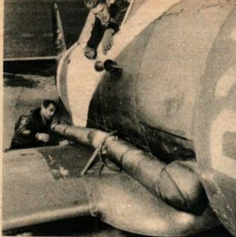
La fumée céleste est déchargée par un tube spécialement conçu, monté le long du fuselage de chaque avion du groupe.
