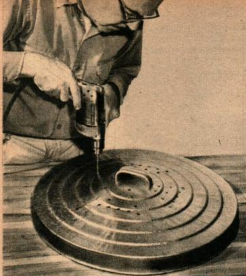
6. Des trous disposés en groupements triangulaires sont percés à travers le couvercle de la poubelle. Ebarbez-les avec un alésoir pour éviter de vous écorcher les mains.
