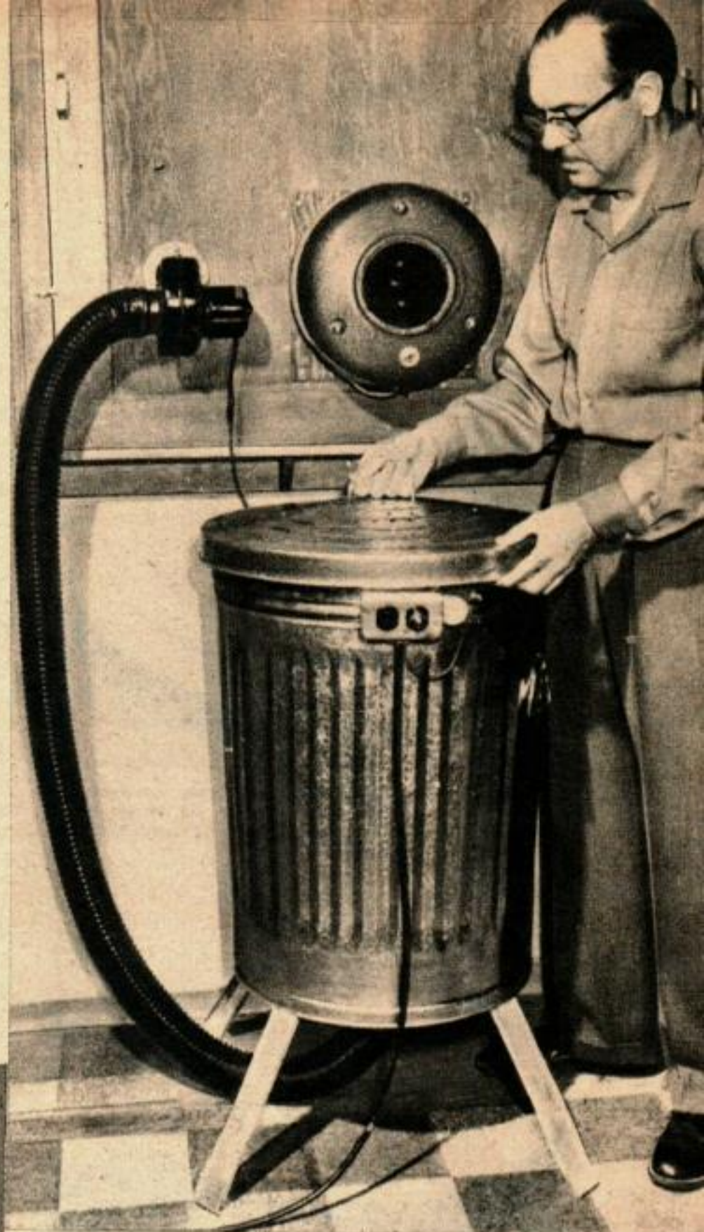
5. Le manchon ou raccord de sortie d'air, ci-dessus à gauche, est soudé dans le trou de la poubelle. Ci-dessus à droite, la sècheuse à films terminée.
