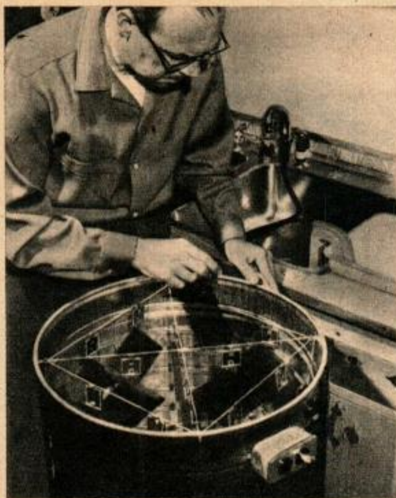
1. La sècheuse peut recevoir jusqu'à 24 négatifs coupés de 10 x 13 cm ou plusieurs bandes de pellicule, suspendus aux supports supérieur et inférieur.
