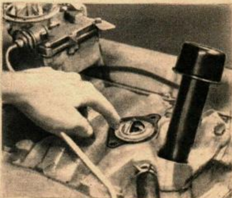
3. Lorsque vous remettez le thermostat en place, assurez-vous qu'il porte bien sur son siège et que le joint plat est à la position correcte. Les boulons de culasse servant à la fixation de la collerette doivent être serrés avec une clé dynamométrique à la tension indiquée sur les spécifications.
