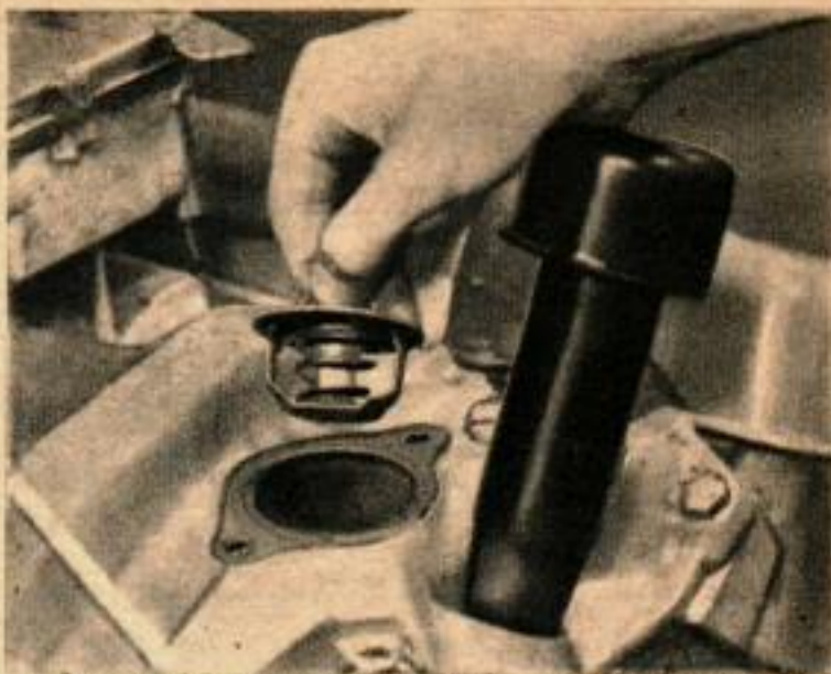
1. Le thermostat devrait être changé chaque fois que l'antigel est vidangé au printemps ou chaque fois que le plein d'antigel est refait à l'automne. Assurez-vous de bien utiliser un thermostat étalonné pour votre climat et pour votre type de conduite.
