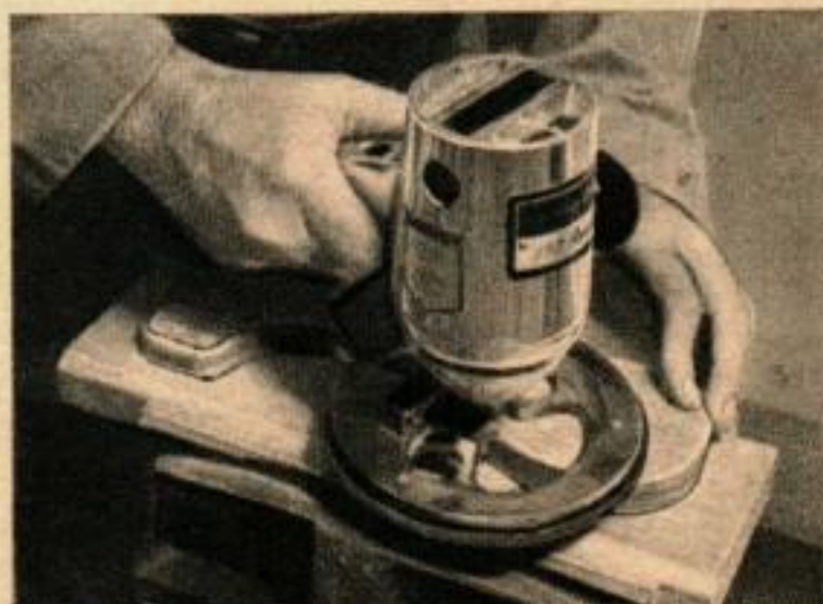
Les membrures latérales du siège de la machine à ramer sont découpées à la scie à découper (ci-dessus) puis ponçées (ci-dessous) pour éliminer toutes les arêtes vives. Les membrures latérales se prolongent toutes les quatre au-dessous des rails pour empêcher le siège de sortir de la voie en roulant.
