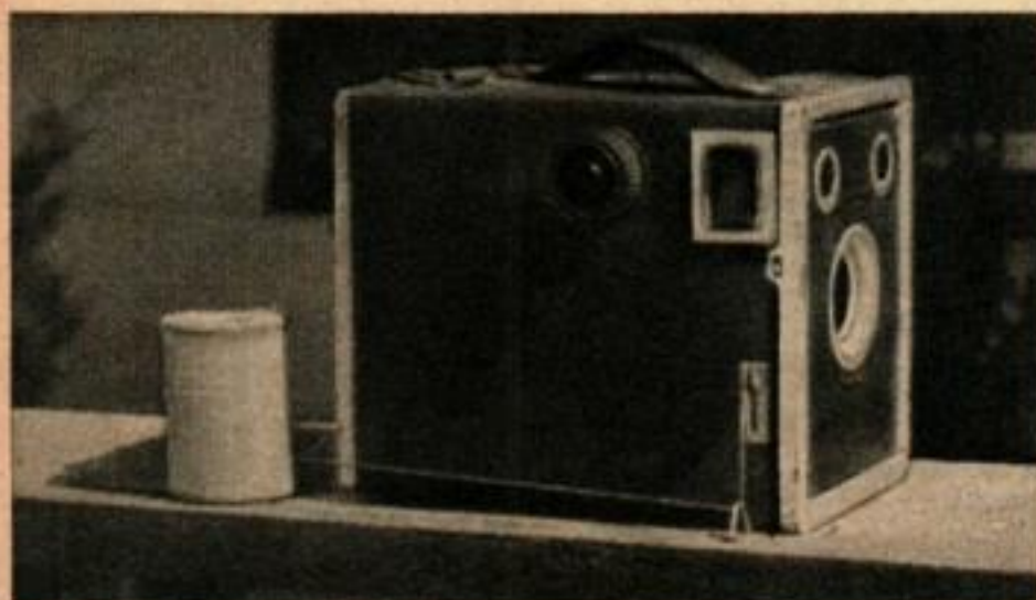
L'appareil type « boîte » (ci-dessous) peut être utilisé pour photographier les oiseaux. Un dispositif à ficelle déclenche l'objectif à partir d'un point éloigné lorsqu'un oiseau se pose sur un point déterminé à l'avance.
