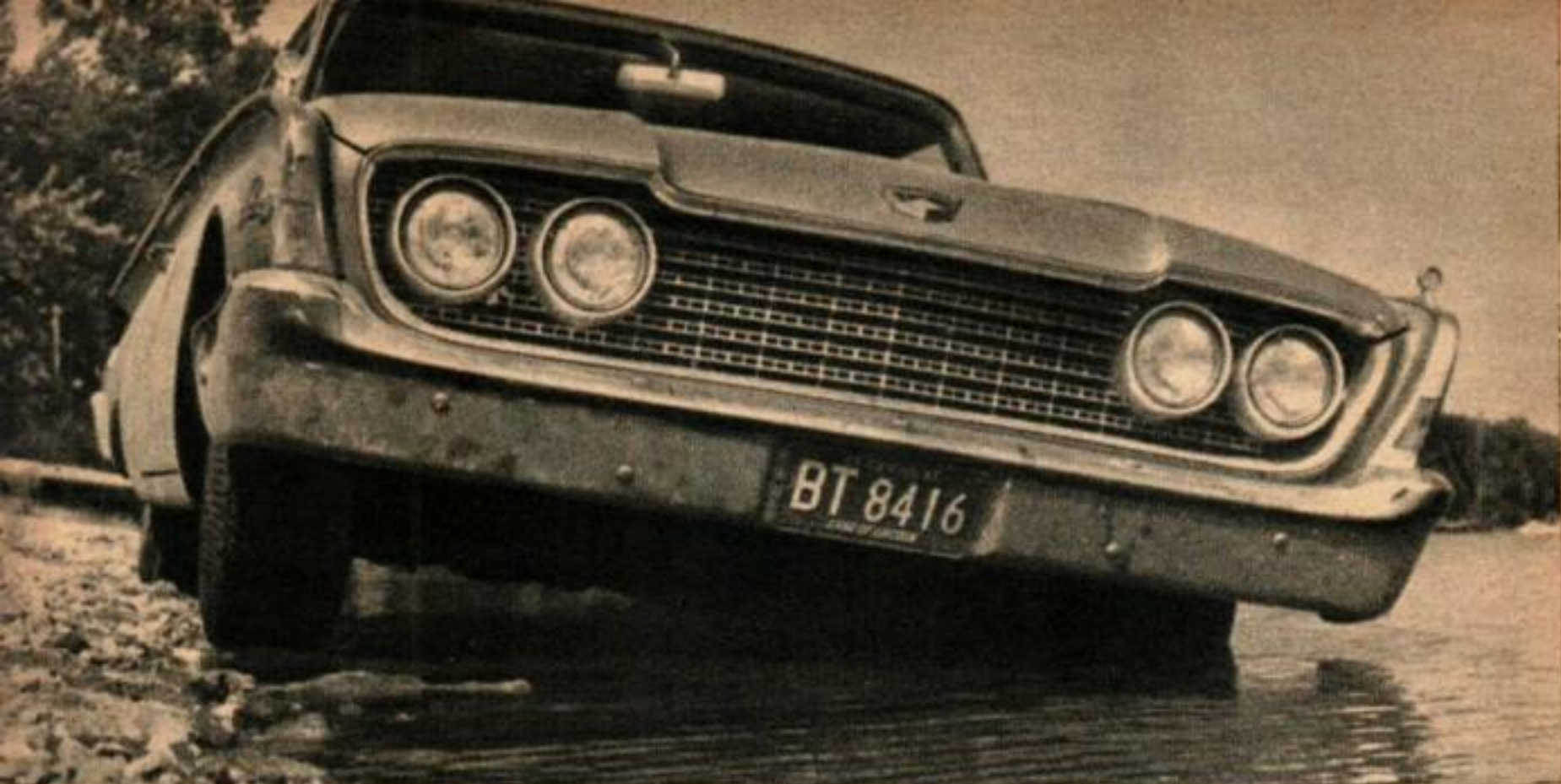
L'essai de la puissance de freinage avec freins mouillés fut conduit en faisant entrer la voiture dans un lac du voisinage afin de tremper les tambours et les garnitures dans l'eau.
