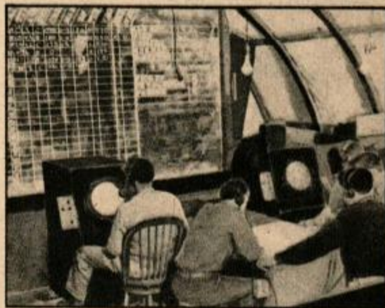
Dans ce poste, les opérateurs de radar contrôlent le trafic aérien et empêchent les collisions dans un rayon de 80 km. environ.
