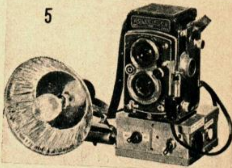
Un solénoïde est utilisé lorsque la boîte est montée sous la base d'un Rolleflex ancien modèle. Si des éclairages latéraux additionnels sont requis, ils peuvent être branchés à travers le boîtier.
