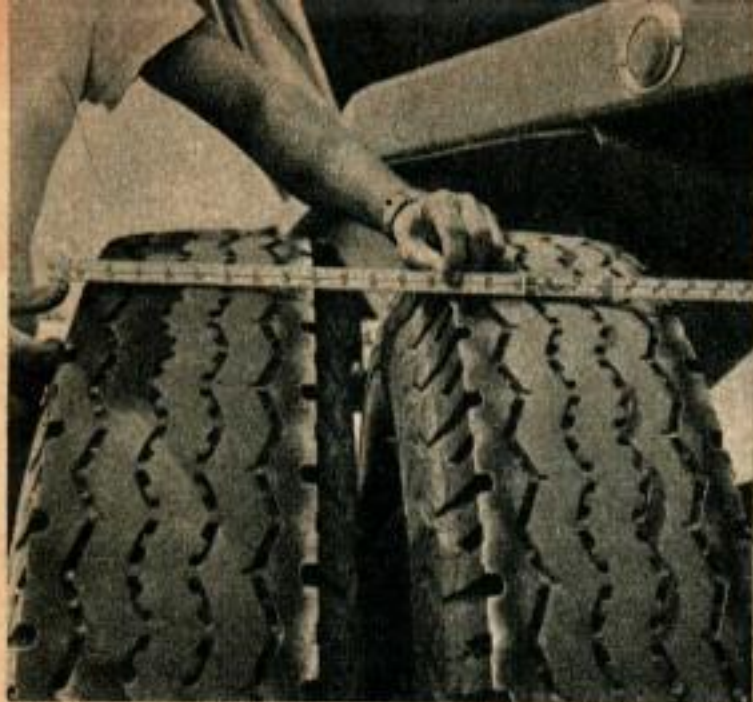
La largeur de bande de roulement des jumelés totalise 19 cm, tout juste un peu plus que le super. Remarquez l'espace perdu entre les roues.
