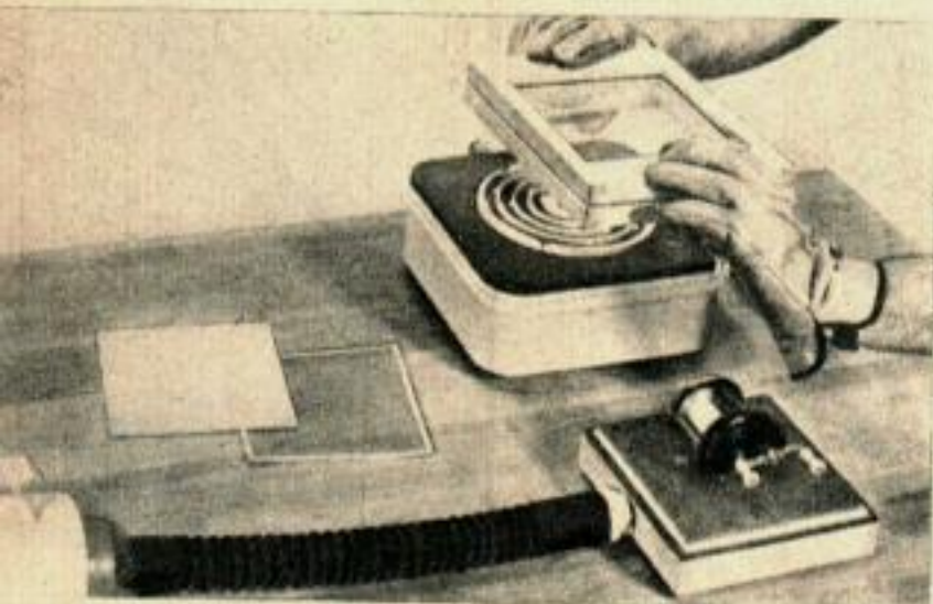
2. La feuille plastique, ci-dessus, est chauffée des deux côtés avec une plaque chauffante électrique pour l'amener au degré de malléabilité voulu pour le façonnage. Puis le châssis et la feuille sont placés sur le modèle sur la boîte à dépression. La pression atmosphérique, ci-dessous, force la matière plastique à entrer en contact avec le modèle.
