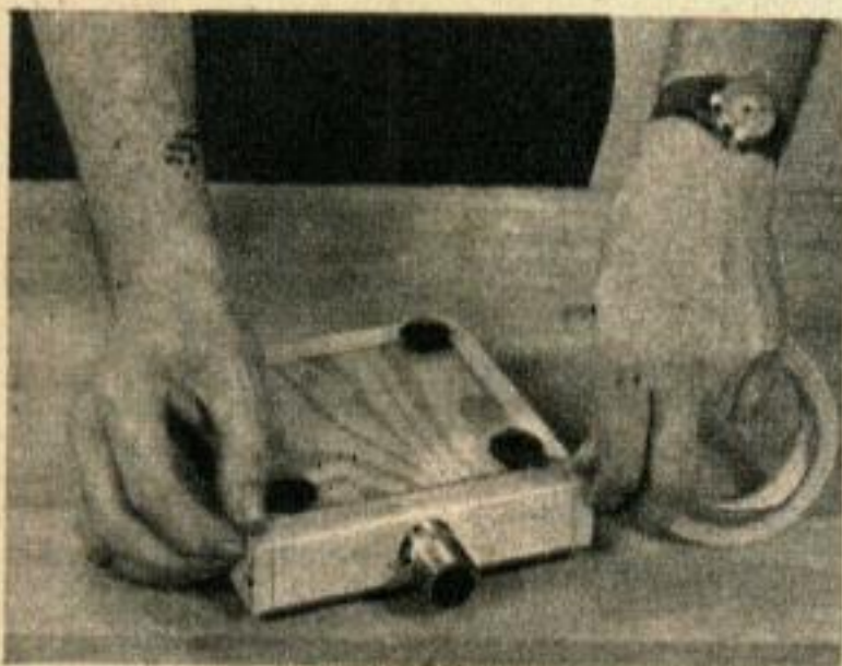
5. Le fond de la chambre à vide est en contreplaqué. Il doit être ajusté très serré pour éviter les infiltrations d'air. Les coins de la boîte sont rendus étanches avec du ruban adhésif.
