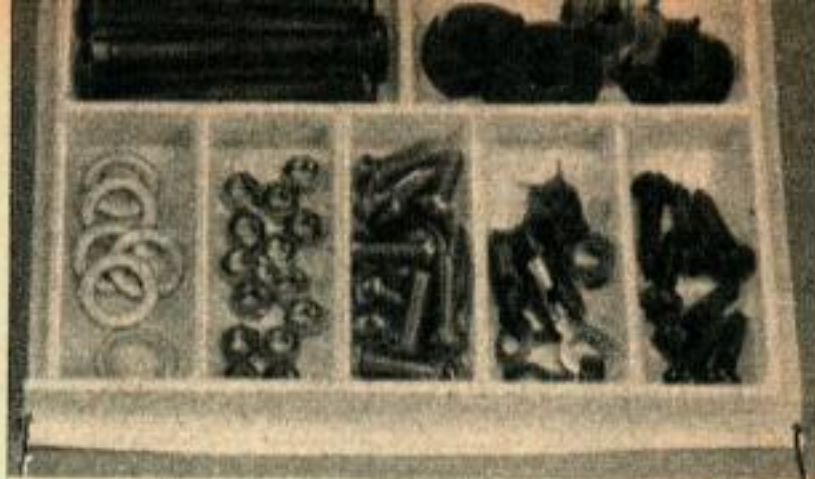
4. Les casiers à petites pièces peuvent être reproduits en matière plastique formée sous vide. Ou vous pouvez monter un casier en matière mince et l'utiliser comme modèle pour former en série n'importe quel nombre de casiers en matière plastique.
