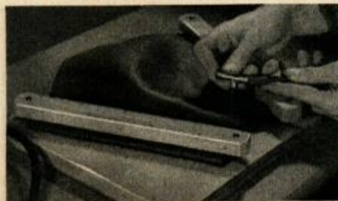
10. Le connecteur en T monté sur la chambre à air en caoutchouc est fait d'un chapeau de valve et d'une pièce de tube de cuivre. Un tubage de seringue relie la chambre au soufflet.
