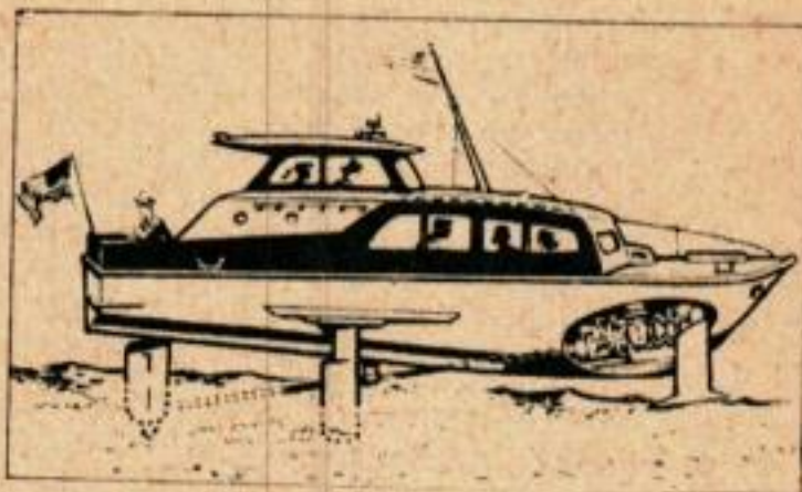
Projet de croiseur de plaisance à plans hydrodynamiques de sustentation et propulsion par turbine montée en proue. La vitesse de pointe serait de près de 75 km/h.
