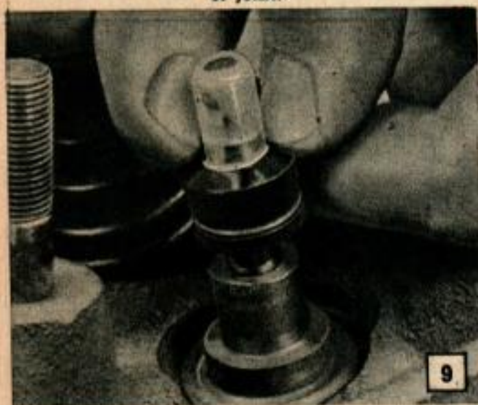
L'installation est relativement simple à exécuter, ainsi que vous le verrez sur les figures de 3 à 11. La figure 5 montre une installation typique utilisant trois types de joints, A, B et C. Dans la pratique, des joints sont montés aussi bien sur les soupapes d'admission que sur les soupapes d'échappement, car l'expérimentation a démontré
