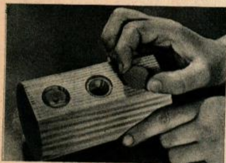
3. La plaque de résonance doit avoir à peu près l'épaisseur d'une carte postale ; elle se colle sur la chambre de résonance, en affleurement avec la surface.
