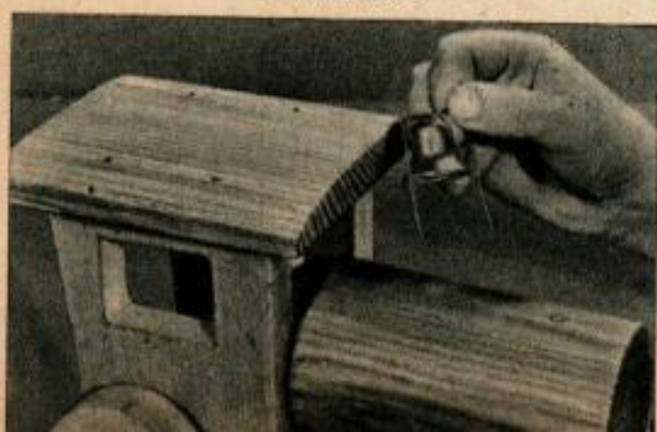
5. La cloche de la locomotive est montée dans une longueur de fil métallique formée en U, avec les extrémités enfoncées dans des trous percés dans la chaudière.
