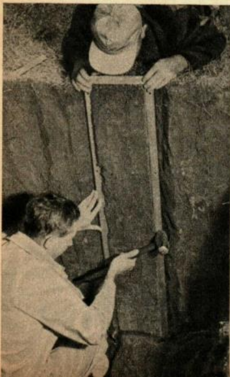
Les échantillons de densité volumétrique montrent la différence de compacité obtenue par diverses méthodes de préparation des lits de semis pour petites graines. Ci-dessous, un cadre métallique est encastré autour d'une bande de profil de terrain, préalablement à l'enlèvement de celle-ci.
