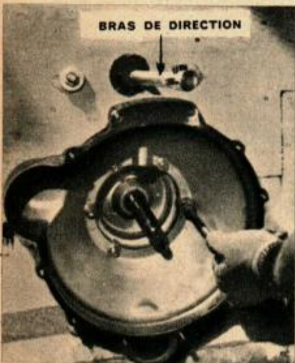
9. Le carter d'embrayage, à gauche, est boulonné sur l'intérieur du tableau arrière, après quoi le moteur est descendu dans le cockpit et boulonné sur le carter d'embrayage, au centre. A droite, l'élément d'entraînement est ajusté sur l'arbre et bloqué en place avec des broches de montage, ce qui complète l'installation à l'exception du branchement des télécommandes, des canalisations de carburant, des systèmes électriques et de refroidissement.
