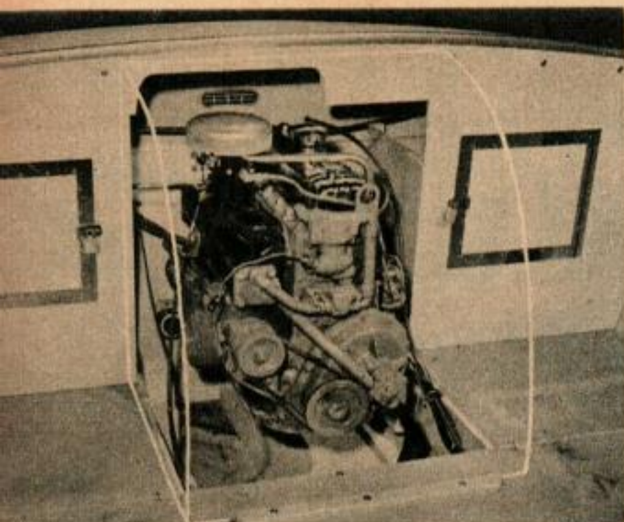
10. Le capotage de moteur indiqué ci-dessus peut être fabriqué en contreplaqué doublé d'un matériau ininflammable et absorbant le bruit. Remarquez les ouvertures des compartiments de rangement à bâbord et tribord et la grille de ventilation extérieure au sommet du tableau arrière.
