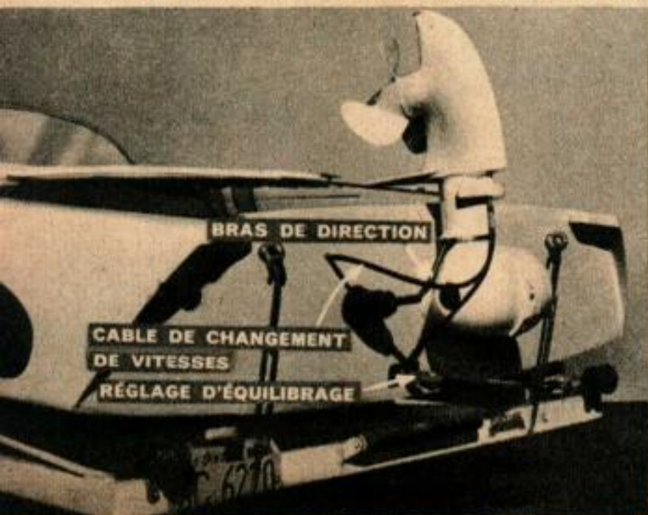
12. L'entraînement extérieur « Sea Hawk » peut être utilisé avec des moteurs de 50 à 300 HP. Il ne pèse que 27 kg et peut se relever sur 180° pour se dégager de l'eau ou des obstacles routiers. L'angle de basculement peut être réglé depuis le siège.
