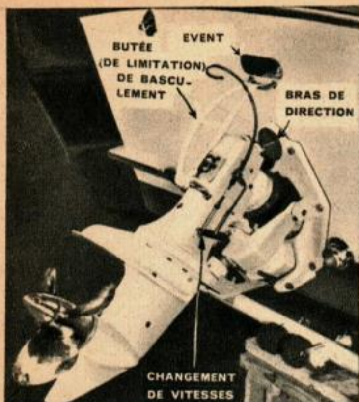
8. Les timoneries de commande de l'élément d'entraînement « Aquamatic », à gauche, sont montées extérieurement, comme c'est le cas avec tous les autres modèles sauf le « Mercruiser ». Les timoneries de commande de ce dernier sont dissimulées dans le carter de l'arbre de transmission. A droite, ce bateau à moteur intérieur de 7,30 m, qui s'est classé premier dans la course Miami-Nassau, fait la démonstration des possibilités de l'installation intérieur-extérieur jumelée.
