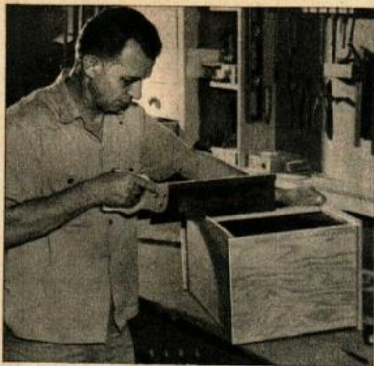
La traverse arrière du tiroir est encochée pour permettre à la glissière rainurée de s'engager sur la baguette de guidage. L'encoche a la même dimension que la rainure.
