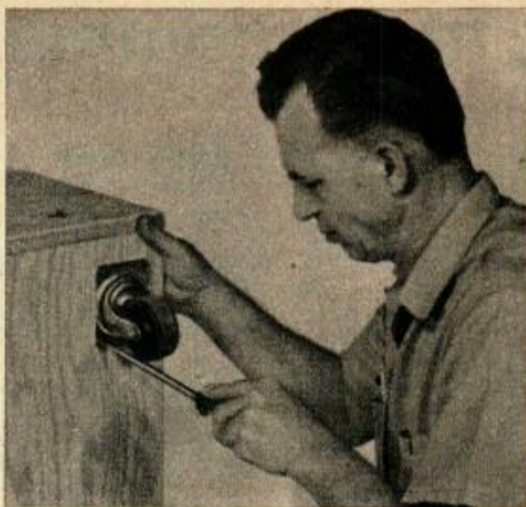
La caisse à outils roule aisément sur des roulettes orientables caoutchoutées. Les plaques de montage des roulettes sont fixées sur le fond avec des vis.
