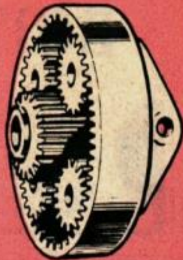
LE TRAIN ÉPICYCLOÏDAL (JEU D'ENGRENAGES A SATELLITES) SERVANT AUX DEMARRAGES EN PREMIÈRE (LOW)
