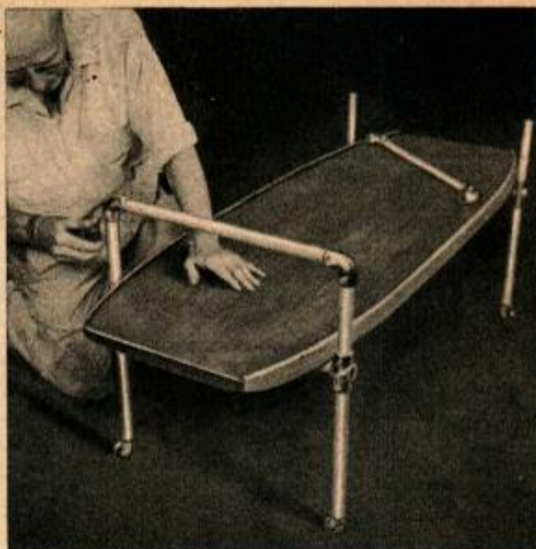
Les poignées sont formées par des rallonges des pieds et des raccords coulés à coulissement.
