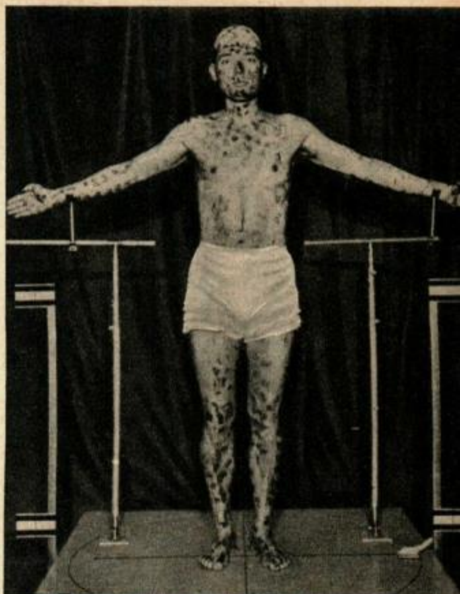
Tacheté de peinture pour former contraste, ce sujet d'essai pose pour la prise de photos par appareil stéréoscopique.
