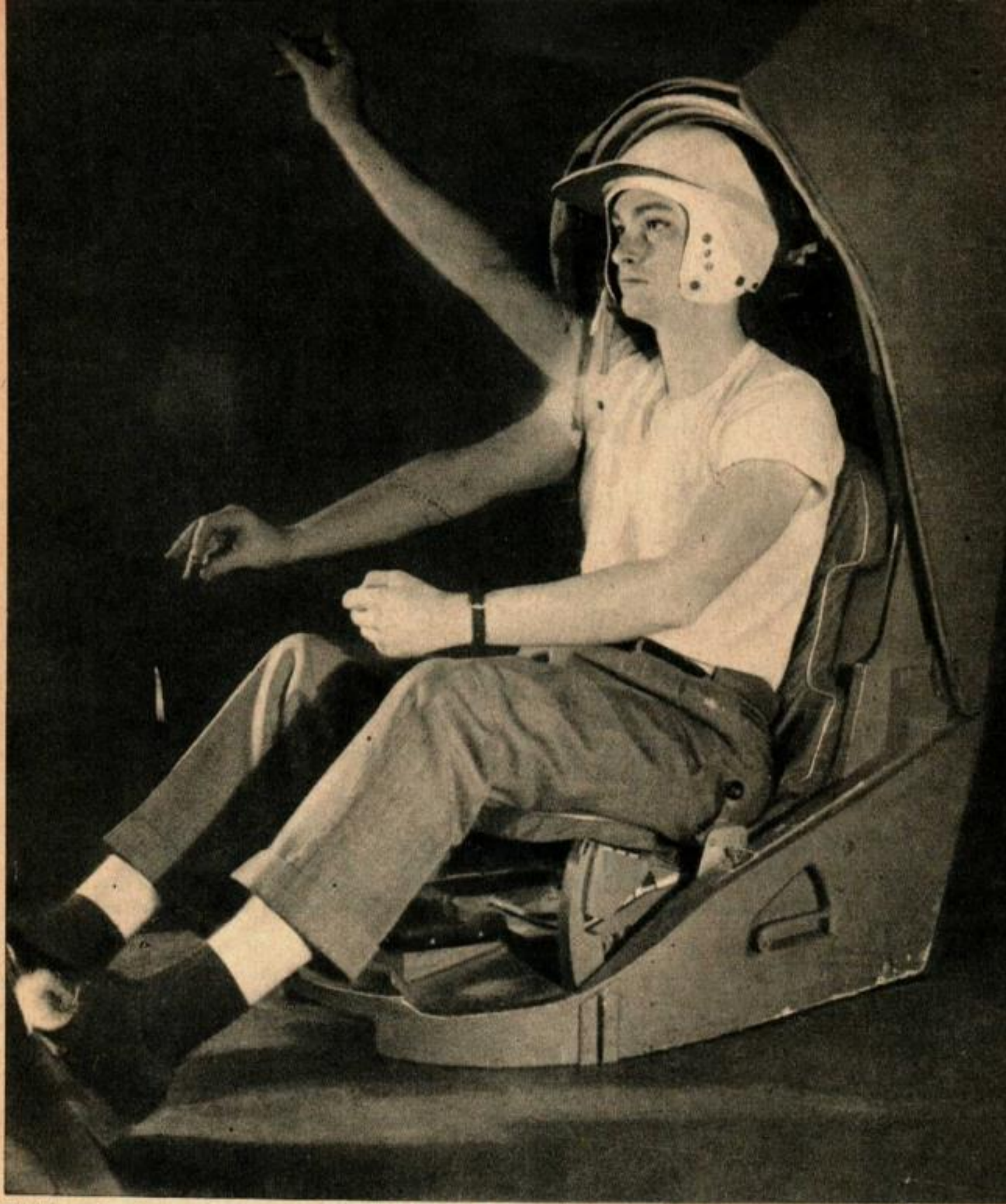
L'atteinte des bras d'un possible homme de l'espace est mesurée photographiquement par une série d'expositions multiples.
