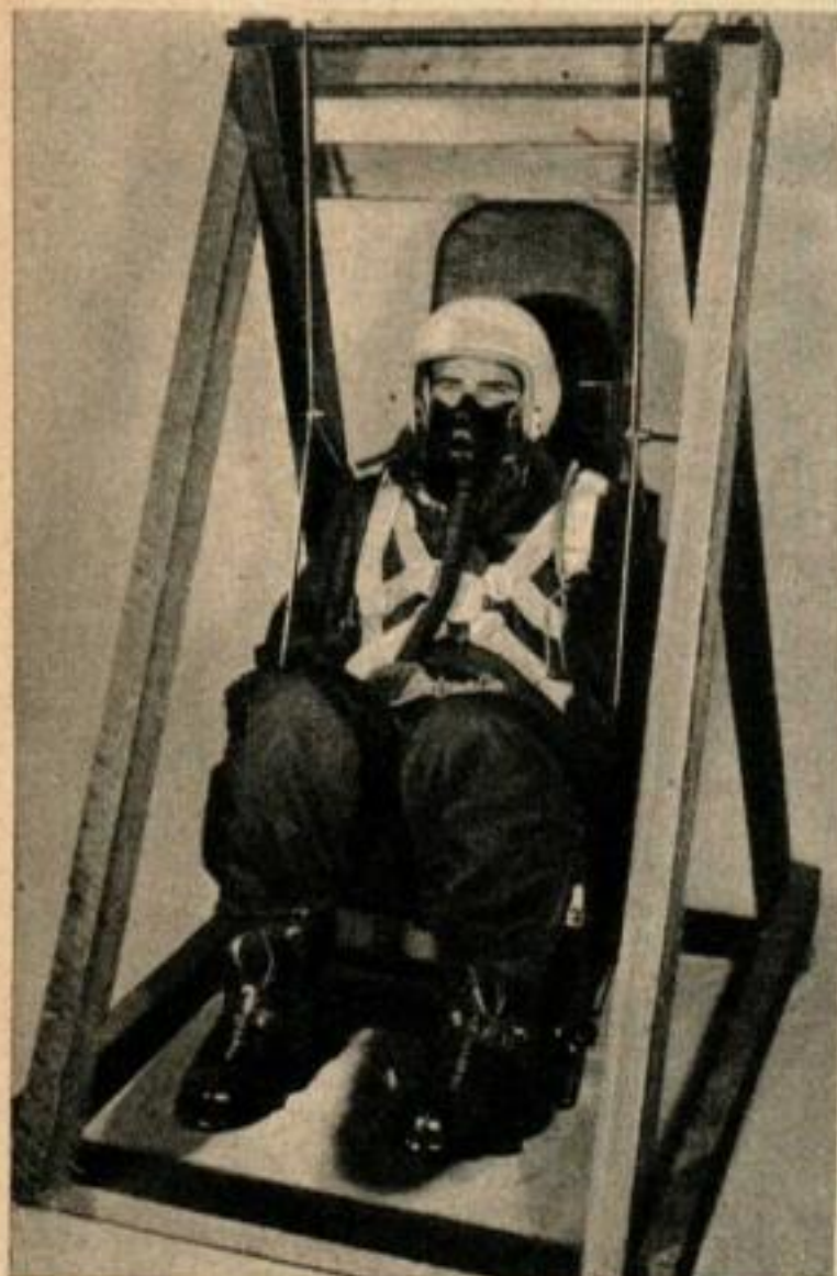
Ce fauteuil à balançoire fonctionne exactement comme celui de bébé, mais il est utilisé pour déterminer le centre de gravité exact du corps.
