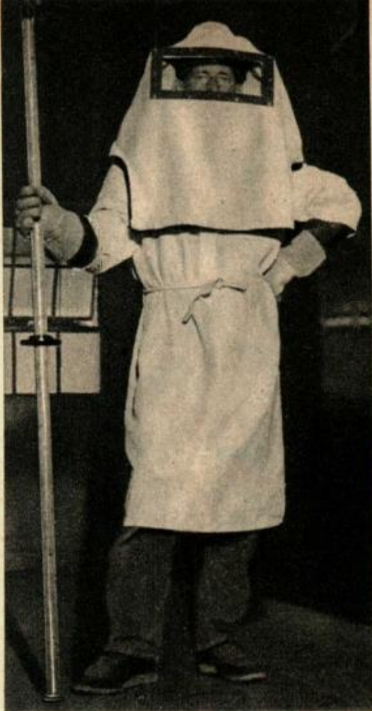
Ce vêtement de sûreté en amiante comprend des gants en caoutchouc et une fenêtre en plexiglas. Il s'utilise dans les trous d'homme.
