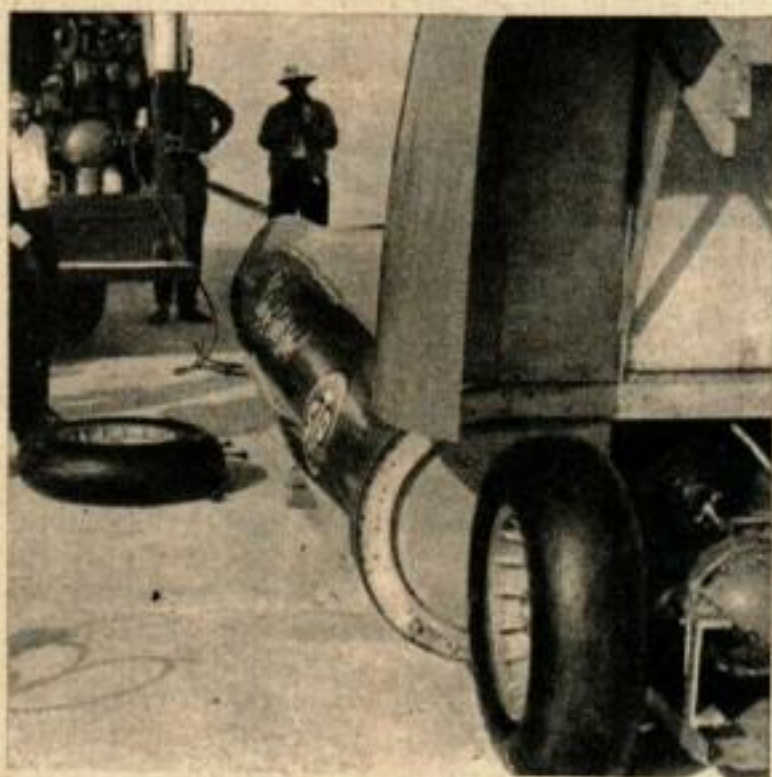
Les pneus spéciaux des « monstres » de Bonneville sont habituellement fabriqués pour une voiture seulement, avec les roues construites à la demande.
