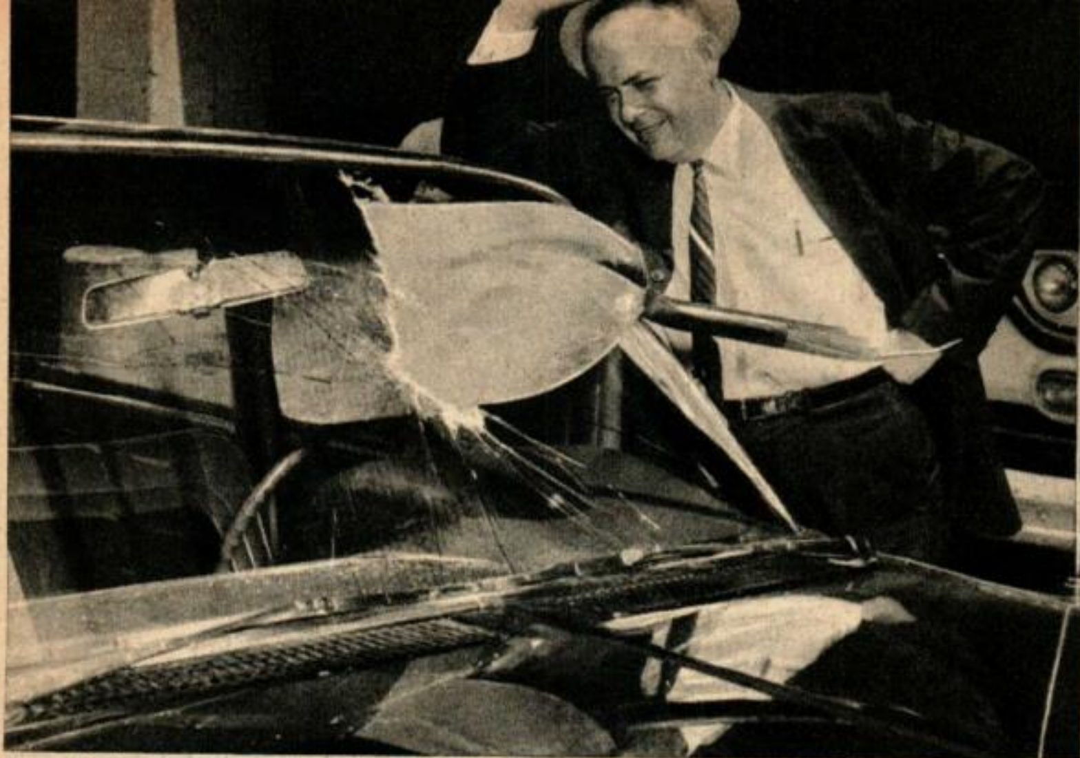
Une pelle tombée d'un camion creva le pare-brise laminé de cette voiture. La résistance du verre laminé à la pénétration par les objets tranchants arrêta la pelle tout juste avant qu'elle atteigne la tête du conducteur.
