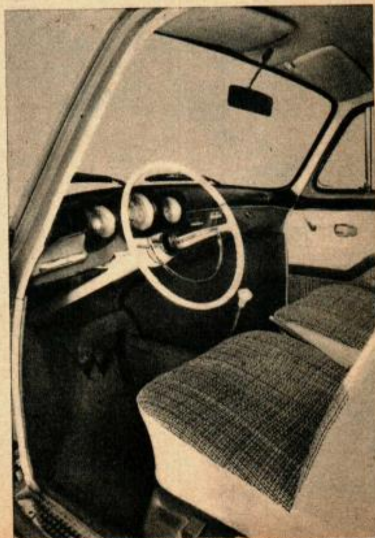
La VW 1500 : tableau de bord avec tachymètre, indicateur de niveau d'essence, montre électrique et boutons de commande
