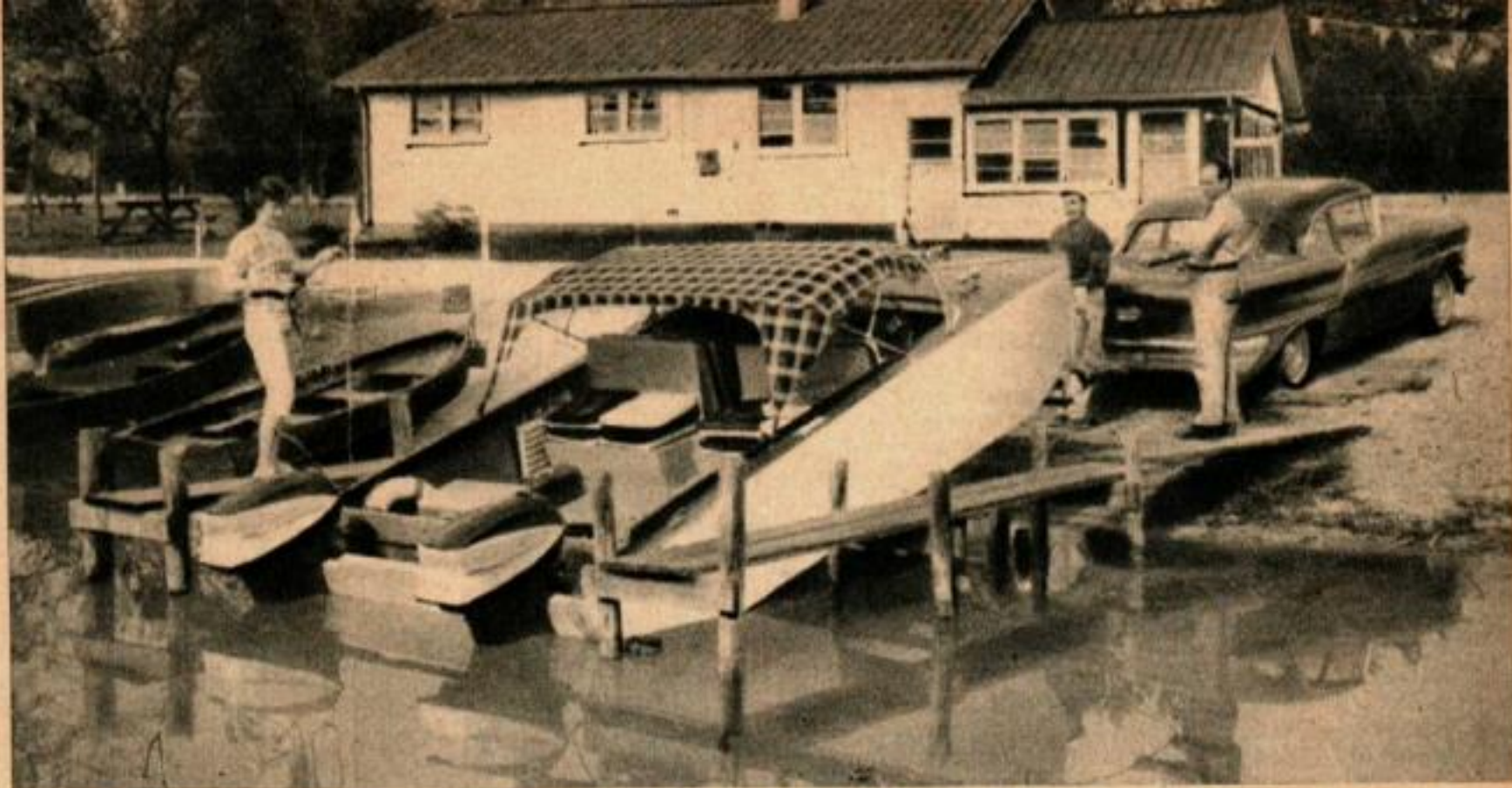
La remorque de catamaran à plateau inclinable permet à un seul homme de lancer et de recharger aisément le Pop-Cat sans même avoir à se mouiller les pieds.
