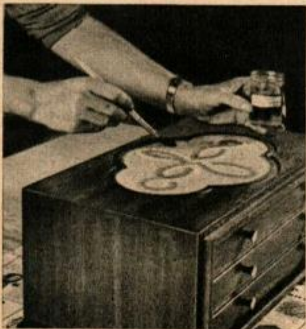
5 Du vernis aux silicones, appliqué au pinceau sur la mosaïque et sur le ciment après séchage de ce dernier, ci-dessous à gauche, conserve plus longtemps son brillant au carrelage. La photo du bas à droite montre comment les petits dés de carrelage doivent être disposés pour élaborer un motif de mosaïque particulier.
