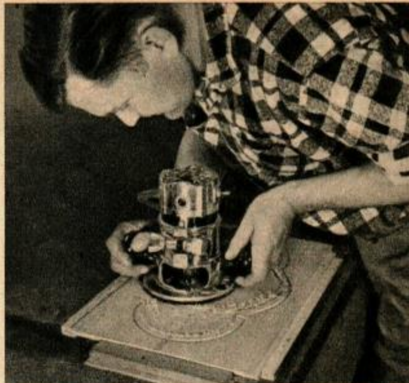
2 Des tasseaux maintiennent le dessus en acajou en place sur le dessus d'établi pour l'usinage de l'évidement de 6 mm de profondeur dans lequel s'encastrent la mosaïque.
