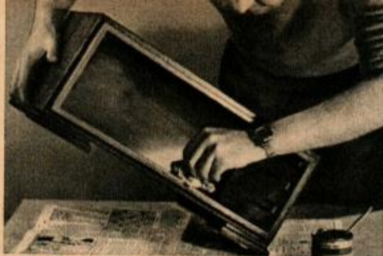
3 De la teinture rouge est frottée en l'incorporant profondément au grain de l'acajou, après quoi trois couches de vernis marine sont passées sur le coffret.
