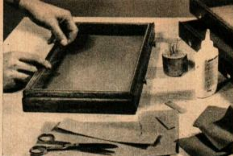
4 La doublure de feutre collée sur les surfaces intérieures des tiroirs est tenue en place avec des épingles ordinaires jusqu'à ce que la colle ait pris.
