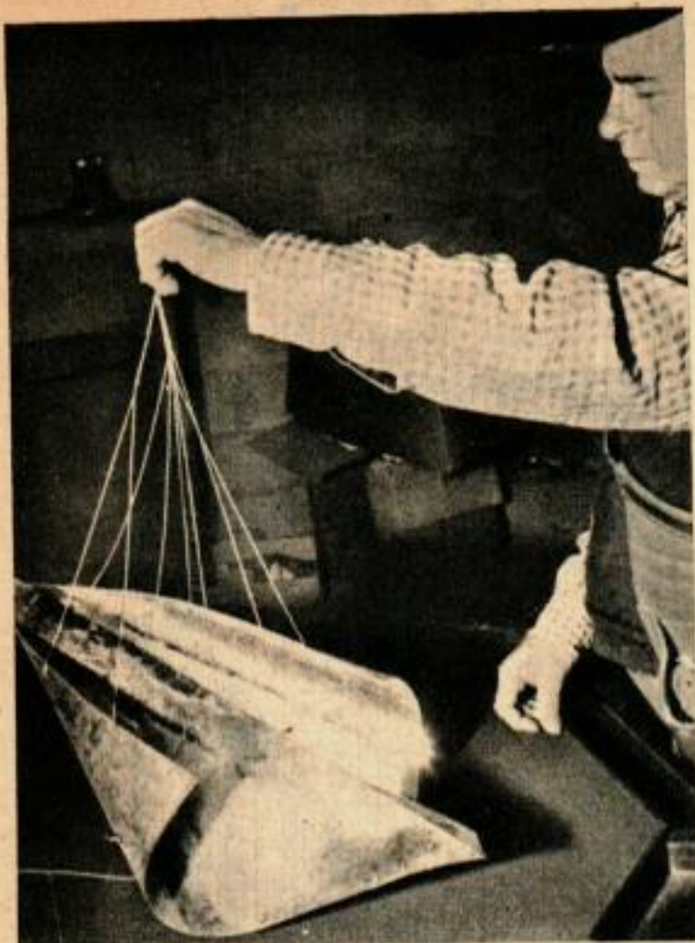
La forme de vol du « Flexkite » est démontrée par Yolen. C'est en tirant toutes les lignes de haubanage en même temps que l'on donne à l'engin l'angle de vol convenable.
