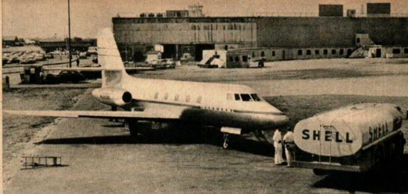
Le Lockheed Jet Star, une autre récente adjonction à la flotte aérienne des affaires, est dans la classe des 965 km/h. Il peut voler sur plus de 2 700 km sans escale ou, avec des réservoirs d'aile additionnels, sur plus de 5 000 km. L'appareil existe aussi en modèle quadrimoteur.
