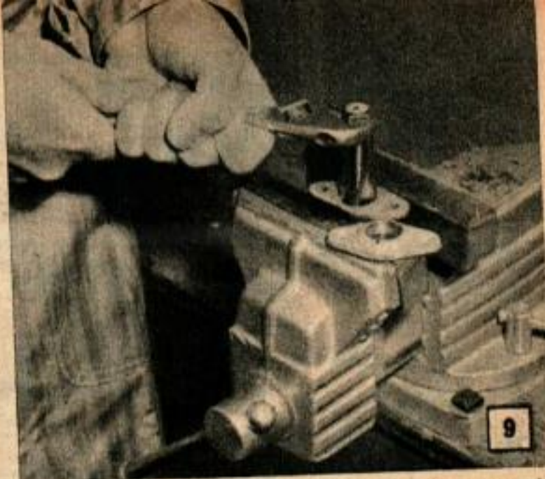
Les écrous de palier sont retaraudés pour recevoir les extrémités filetés du pivot de basculement, qui est usiné dans un raccord fileté droite de 12 \times 305 mm.
