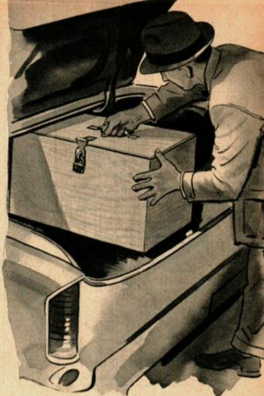
Le casier intérieur se soulève de la caisse à combinaison et celle-ci devient une chambre noire étanche à la lumière pour le chargement et le changement des pellicules.
