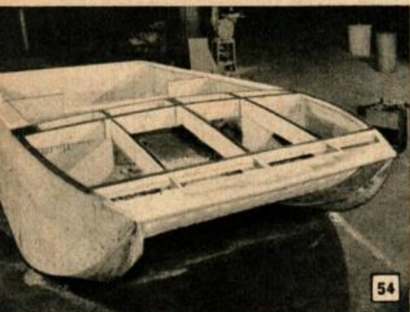
La charpente du pont et les dessous de pont, ci-dessous, ont été carénés et sont prêts à recevoir les plaques de revêtement. Ci-dessous, le panneau du pontage avant est cloué, en partant du centre et en travaillant vers l'extérieur.
