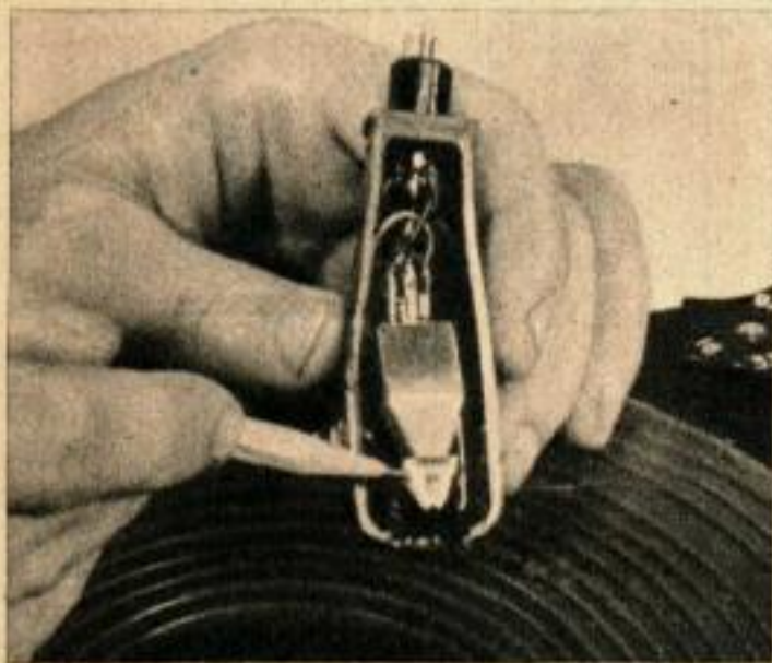
Le montage des aiguilles Pickering est contenu presque en entier dans un boîtier en matière plastique. Faire glisser d'avant en arrière sur les rainures guides.
