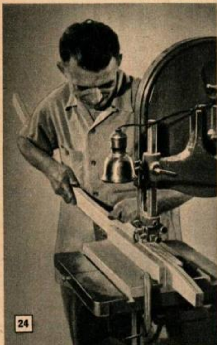
Un montage serré à la presse sur le plateau de la scie à ruban facilite beaucoup la coupe des laminations en épicea utilisées pour la confection des quilles d'angle.
