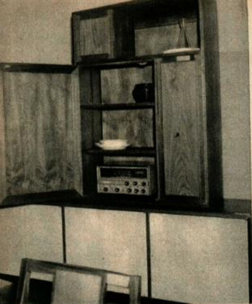
Une station dans une armoire ; l'émetteur-récepteur complet 6 et 2 m, Hallicrafter SR-34, ne prend que très peu de place.
