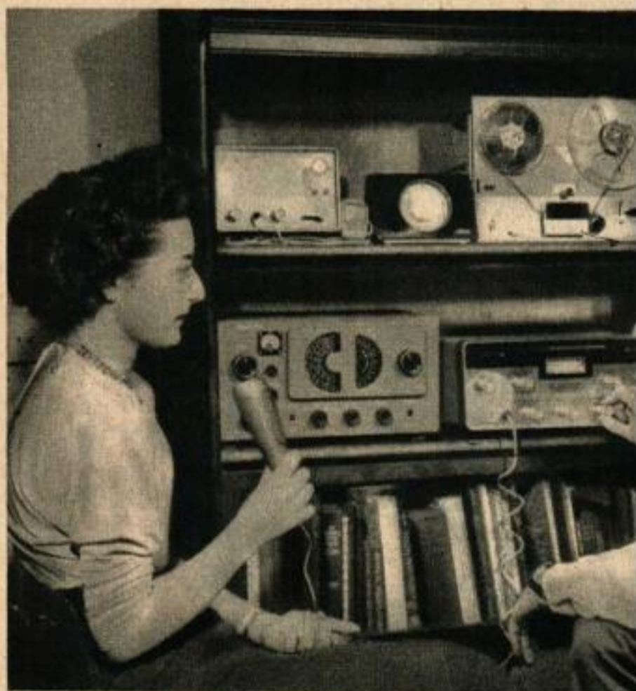
Le récepteur Knight-Kit R-100, l'émetteur Nell Beta 6 m, le convertisseur Viking 6 N 2 et le micro Lafayette — soit une station d'amateur complète et bien rassemblée — se trouve contenue dans la « bureau » de ce meuble mural à sections différentes.
