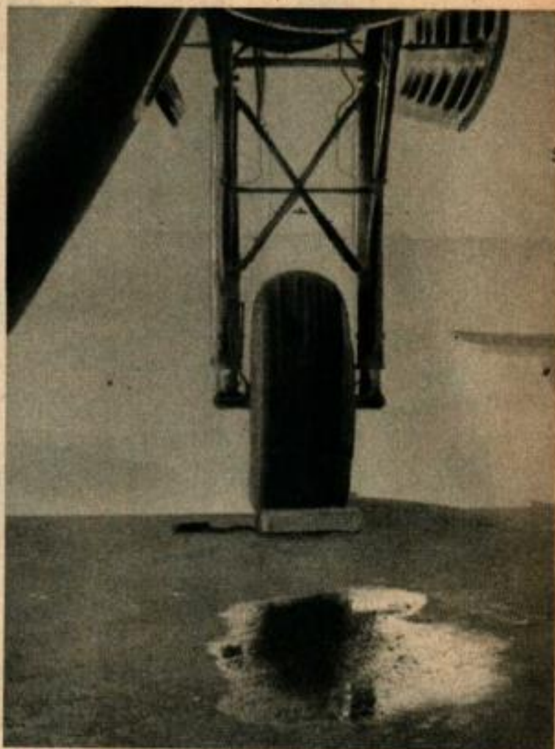
Cette mare d'huile est la triste indication d'une impropre utilisation : manque d'entretien, ou avion trop vieux pour voler encore.
