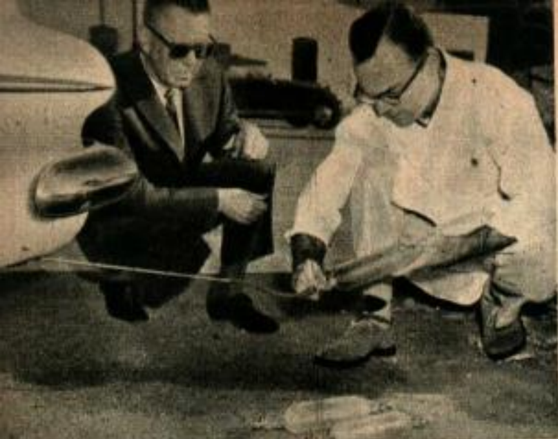
Les fusées d'échappement sont aspirées et embouteillées afin qu'elles puissent être analysées pour leur teneur en particules d'hydrocarbures productrices de « smog ».
