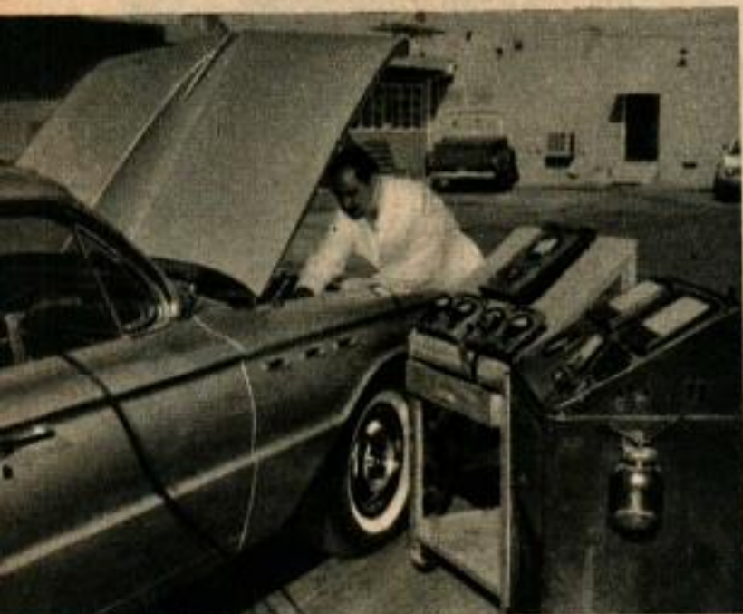
La voiture d'essai de « Mécanique Populaire » est connectée aux commandes du dynamomètre. Ci-dessous est représenté le montage que R. N. Metcalf, le fabricant de l'additif, utilise pour vérifier le kilométrage obtenu avec divers échantillons de carburant. Une augmentation de kilométrage de 10 % est habituellement obtenue grâce au produit.
