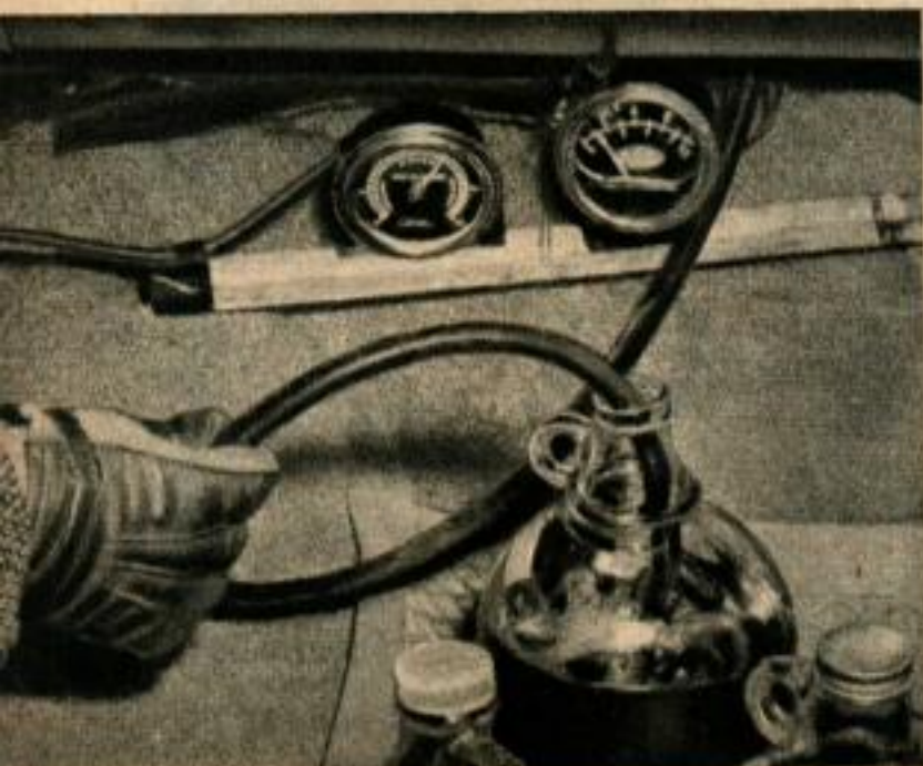
La voiture d'essai de « Mécanique Populaire » est connectée aux commandes du dynamomètre. Ci-dessous est représenté le montage que R. N. Metcalf, le fabricant de l'additif, utilise pour vérifier le kilométrage obtenu avec divers échantillons de carburant. Une augmentation de kilométrage de 10 % est habituellement obtenue grâce au produit.
