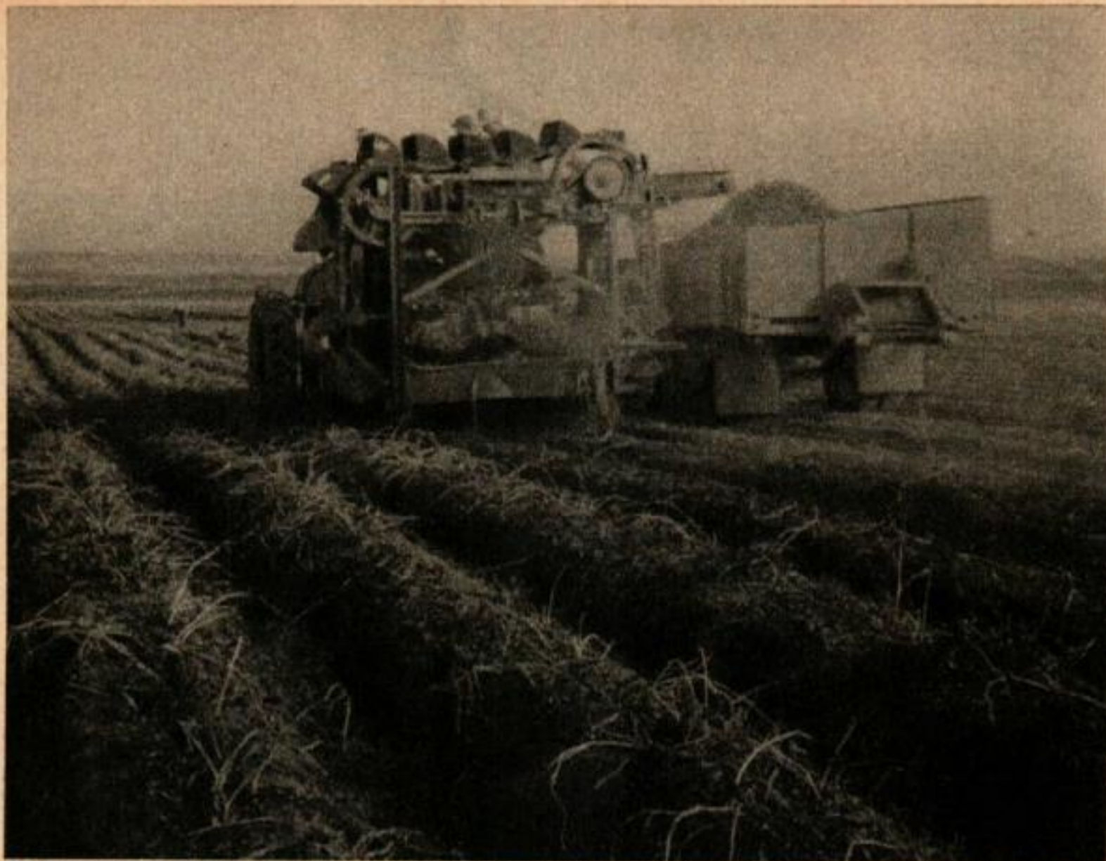
Se déplaçant en même temps que le camion, une arracheuse combinée extrait les pommes de terre du sol, les débarrasse des débris et les déverse dans une benne rembourrée de caoutchouc.
