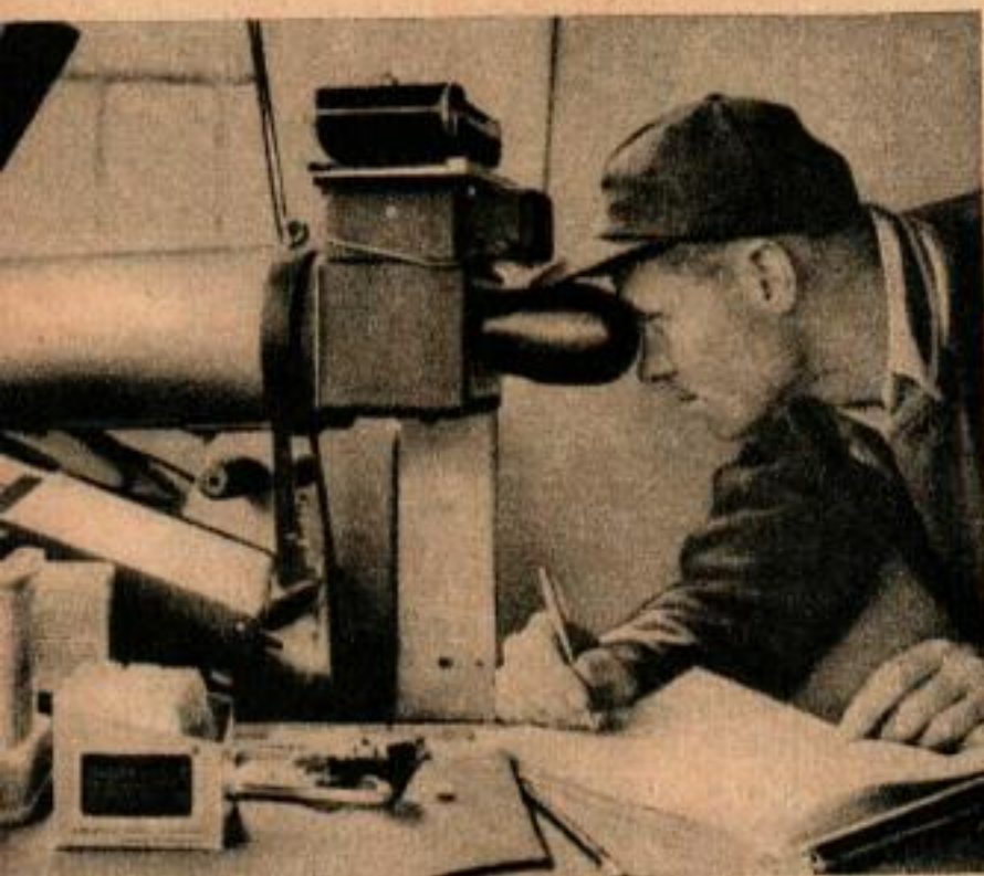
Un appareil photographique polaroïd, monté sur un poste de radar, donne une photo immédiate au moment de la prise de vue. Ci-dessous, la mise de feu des explosions était commandée à partir de la cabine du bateau fluvial.
