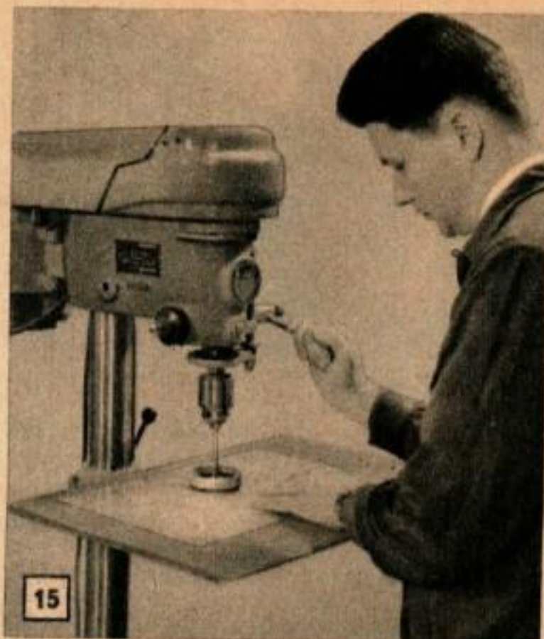
Le perçage de trous dans le verre s'exécute sur une perceuse à colonne, en utilisant un foret et une mixture d'huile et d'abrasif adéquats. Utilisez la vitesse la plus réduite et relevez fréquemment le foret.
